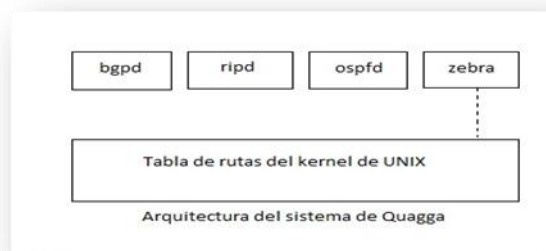
Figura 3-8 Arquitectura del sistema de Quagga
