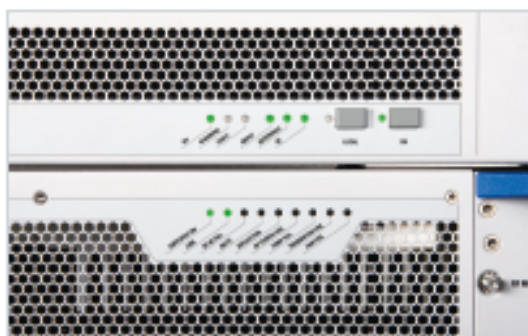
Indicación del estado del transmisor por medio de LED en el panel frontal.
