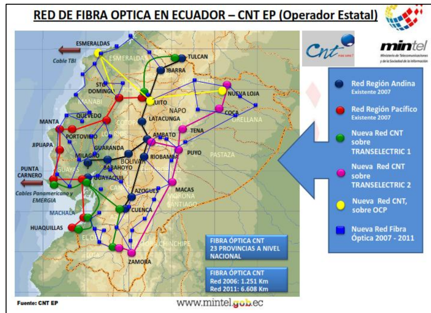
Figura 4.22 Red de fibra óptica de CNT EP en Ecuador
