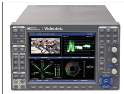
Figura 5.27 Multi-formato Monitor de Forma de onda, Analizador de señales de audio y video [45]
