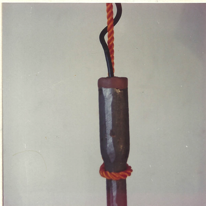
Fig. Nº 20 Sujección del ánodo.
