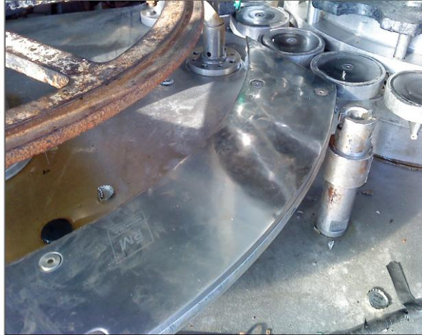
**Fig. 15** Nuevo guía de deslizamiento de botellas
