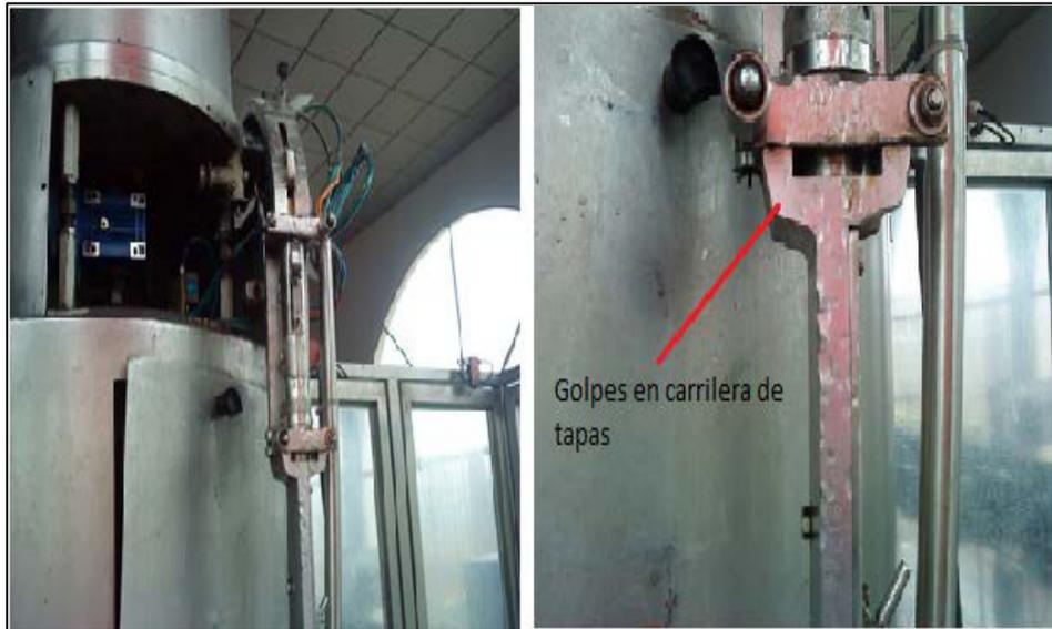
**Fig. 14 Deterioro carrilera de tapas**
