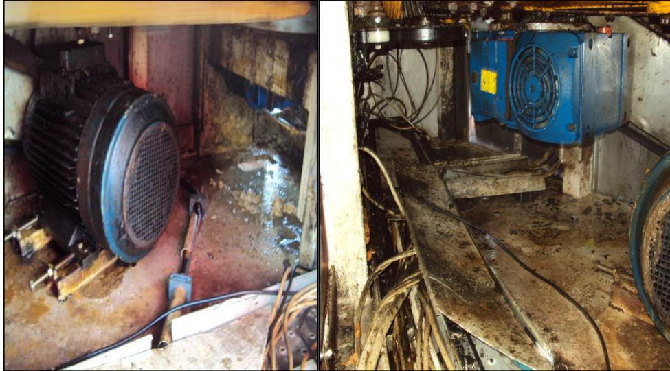
**Fig. 4 Parte interna de llenadora con vidrio y cables sueltos**
