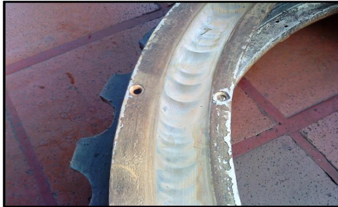
**Fig. 12 Guía de deslizamiento desgastada**
