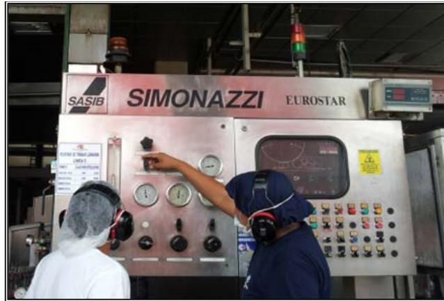
**Fig. 7 Explicación de funcionamiento manómetros llenadora 5**
