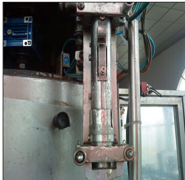
**Fig. 5. Deterioro de alimentador de tapas por golpes**
