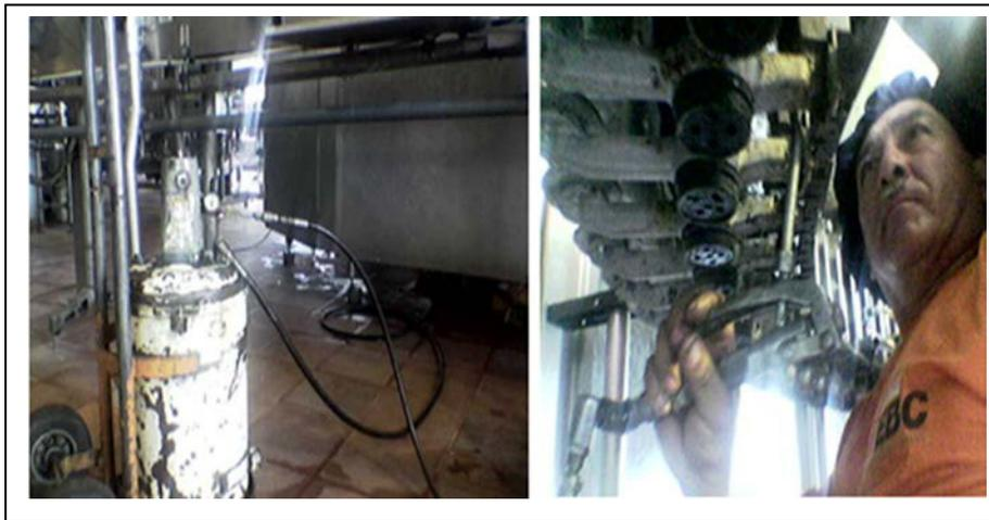
**Fig. 19 Lubricación de llenadora de botellas**
