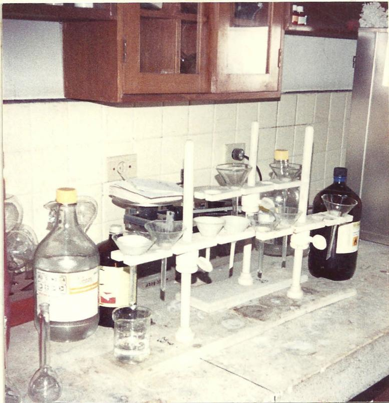
Fig. N°13. Filtración de muestra.
