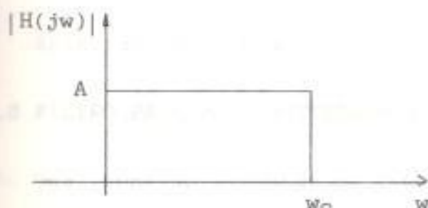
FIG. 4.2 RESPUESTA DE MAGNITUD DE UN FILTRO IDEAL
