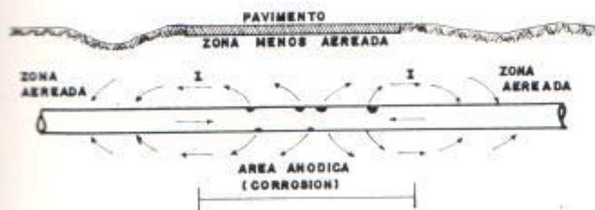
FIG. 1.11.- CELDA POR AERACION DIFERENCIAL PRESENTE EN EL CRUCE DE UNA TUBERIA CON EL PAVIMENTO.
