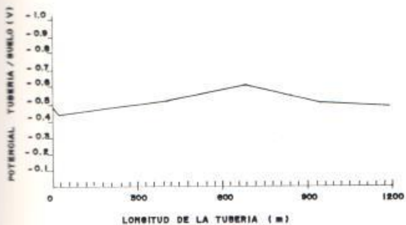
Fig. 2.5.- PERFIL DE POTENCIALES (INSPECCION CON ELECTRODO REMOTO).
