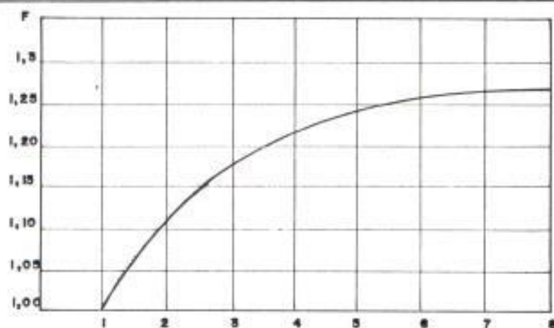
Fig. 3.8.- FACTOR DE CORRECCION DE LA CORRIENTE EN FUNCION DE LA VELOCIDAD DEL ELECTROLITO.
