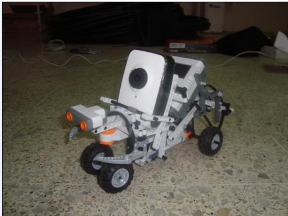
Fig. 1.2 Estructura del robot con la cámara incorporada
