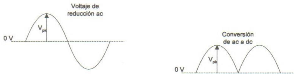
Figura 6.4. Formas de onda de salida
