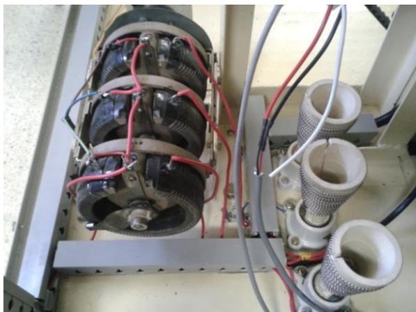
Figura 4.2 Panel de control del sistema frecuencia-voltaje
