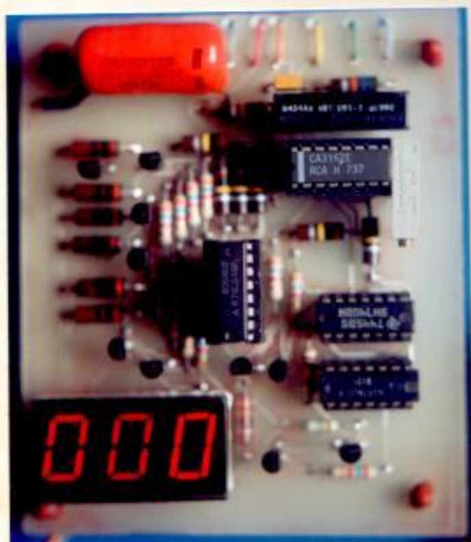
TARJETA # 5 CIRCUITO CONVERTIDOR A/D Fotografía # 6.3
