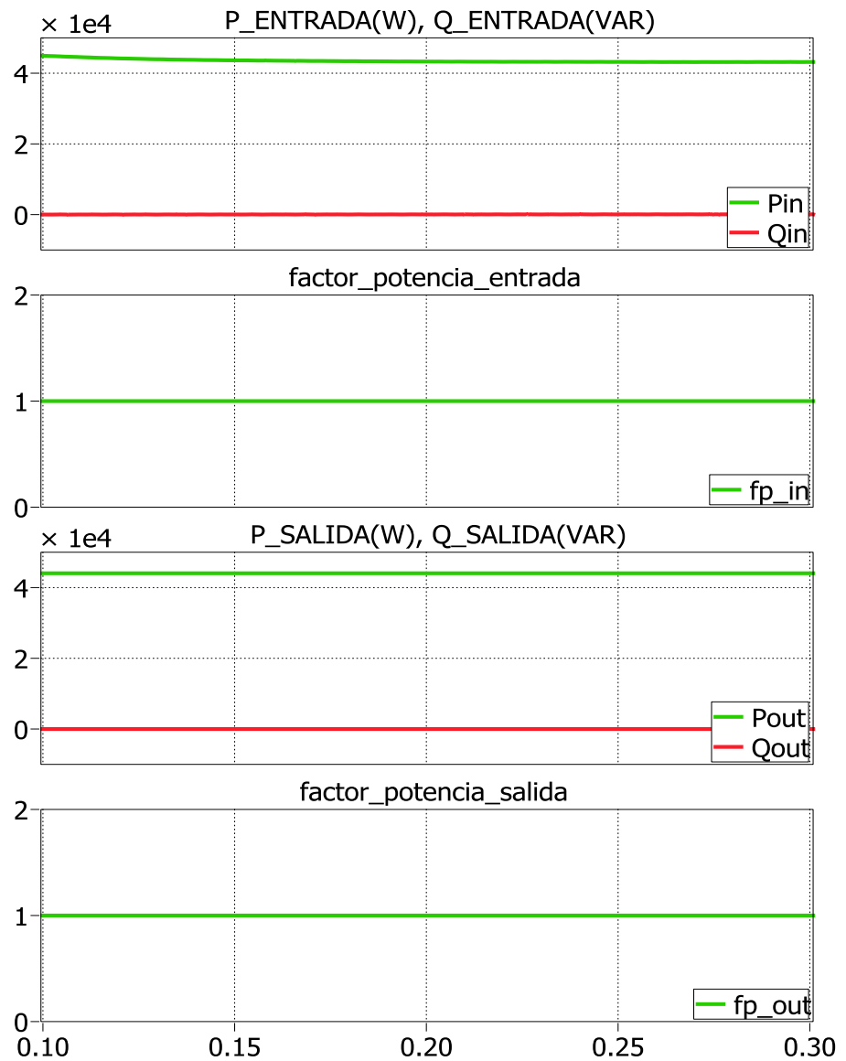
Fig. 5.20. Potencia de entrada y salida, fp de entrada y salida
