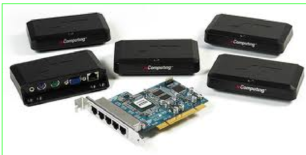
Figura 2.3: Tarjeta de interfaz para CPU principal y 5 módulos NCOMPUTING [6]
