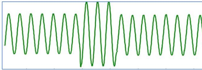
Fig. 2.9 Elevación de tensión Swell [8].
