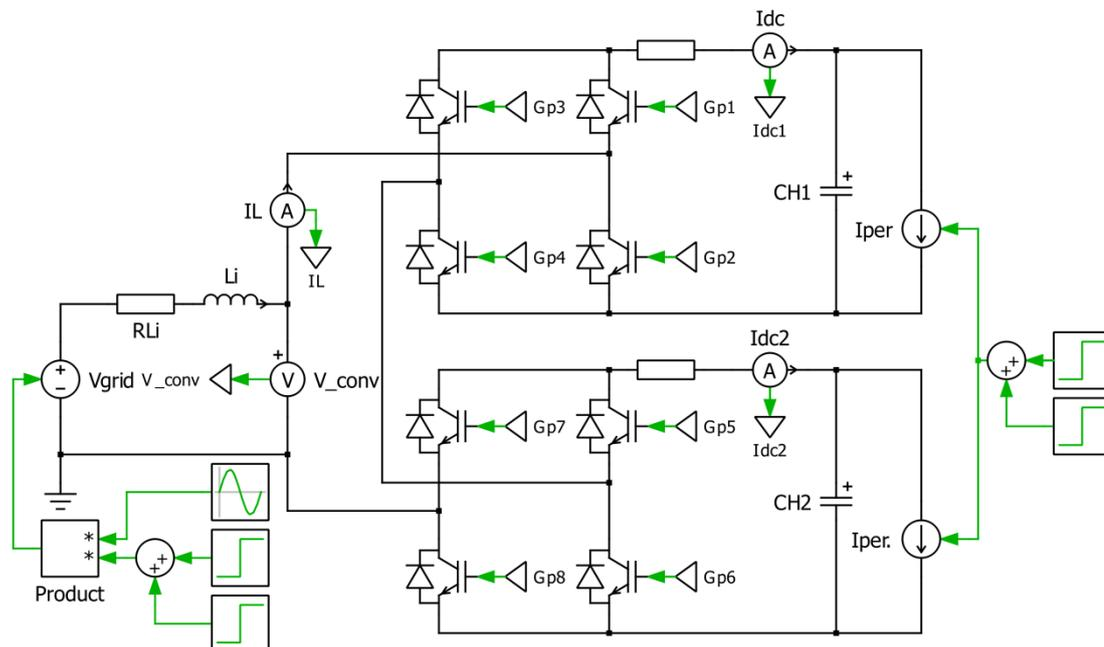
Fig. 4.8 Etapa AC-DC perturbaciones de voltaje y corriente.
