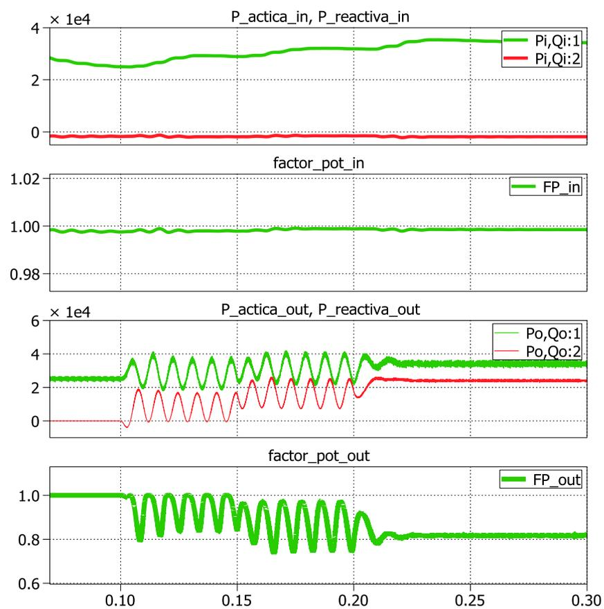
Fig. 5.21 Potencia y Factor de potencia del SST con conexión de carga R-L fase por fase.
