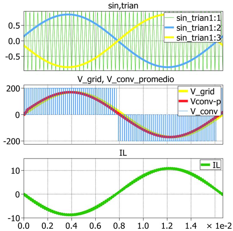
Fig. 2.23 Formas de onda del convertidor DC-AC.
