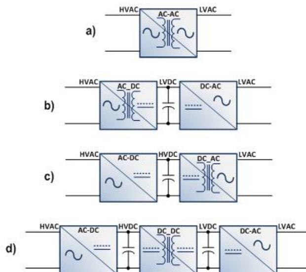
Fig. 2.13 Topologías del SST: a) una etapa, b) dos etapas con LVDC link, c) dos etapas con HVDC link, d) tres etapas [13].
