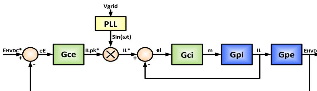
Fig. 4.2 Diagrama de bloque del controlador de la etapa AC-DC.
