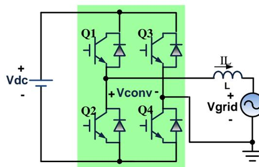
Fig. 2.22 Convertidor DC-AC.
