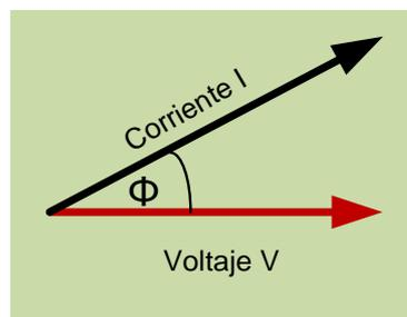
Fig. 2.7 Factor de potencia.
