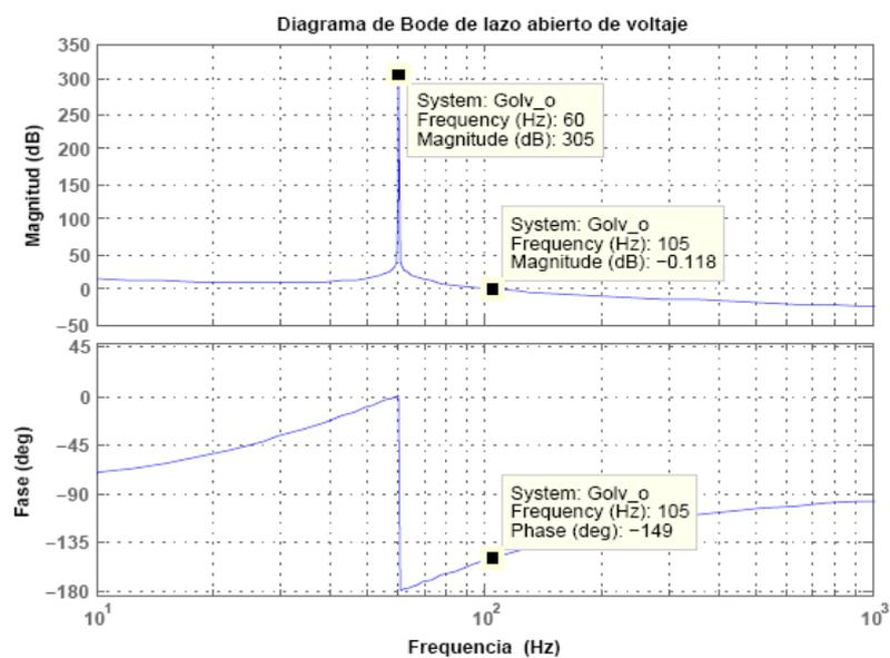
Fig. 4.19 Diagrama de bode de voltaje del convertidor DC-AC.
