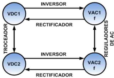
Fig. 2.18 Tipos de convertidores estáticos.
