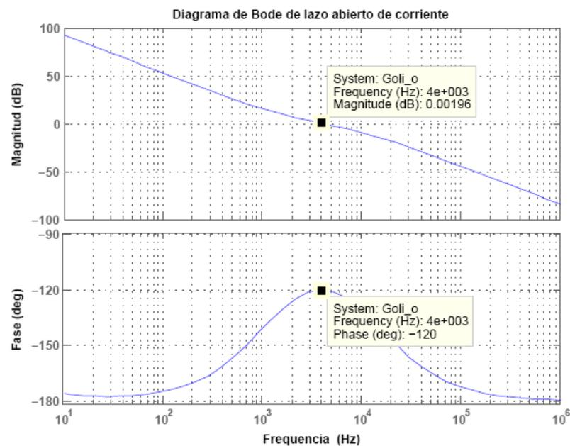
Fig. 4.18 Diagrama de bode de corriente del convertidor DC-AC.
