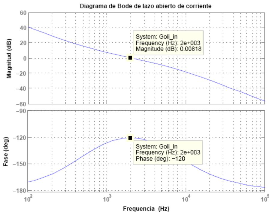
Fig. 4.6 Diagrama de bode de corriente del convertidor AC-DC.
