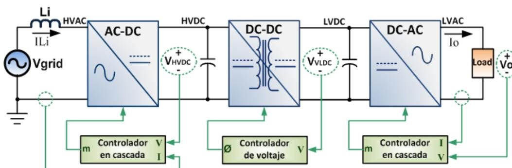
Fig. 4.1 Esquema general de control del SST.
