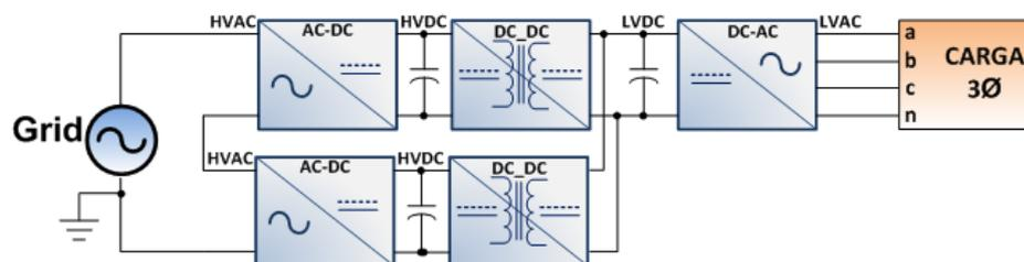
Fig. 2.14 Topología de un SST de tres etapas con 2 módulos en cascada.
