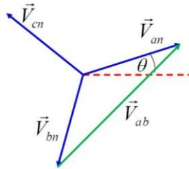
Fig. 2.26 Voltajes en la salida del inversor trifásico.
