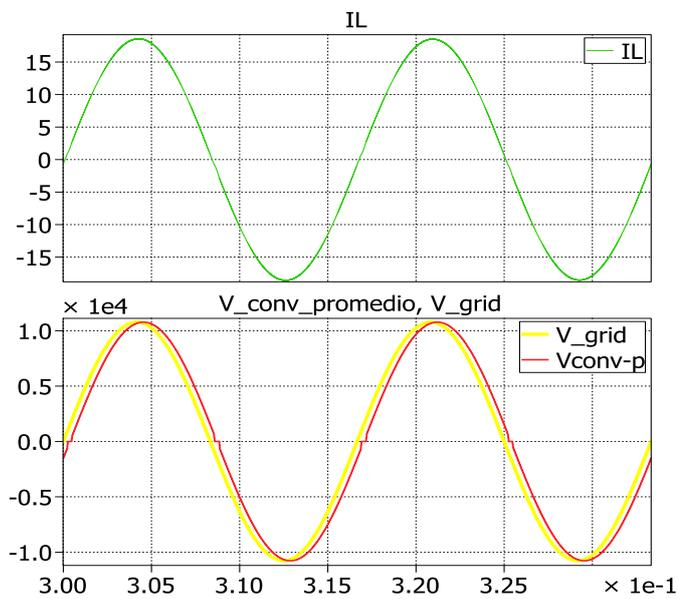
Fig. 3.3 Corriente  $I_L$ , voltaje de la red y del convertidor.
