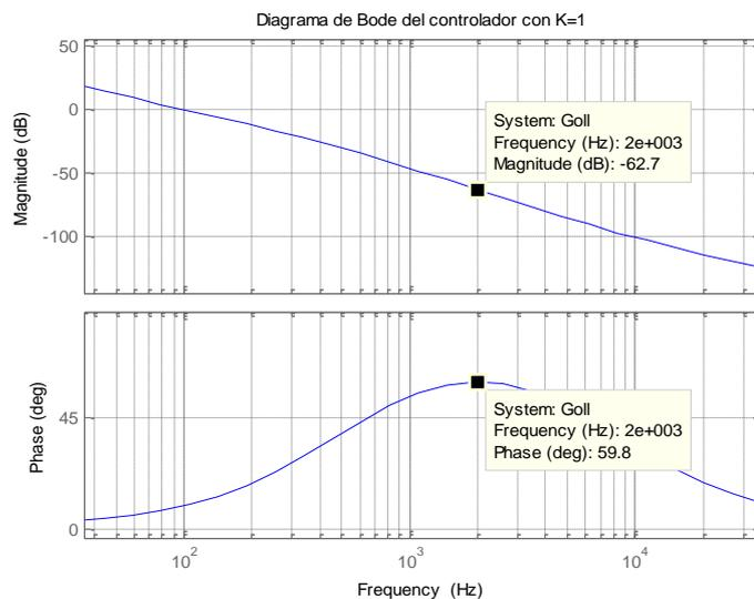
Fig. 4.5 Diagrama de bode del controlador de corriente con K=1.
