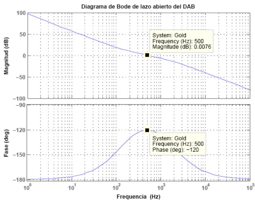
Fig. 4.12 Diagrama de bode del DAB.
