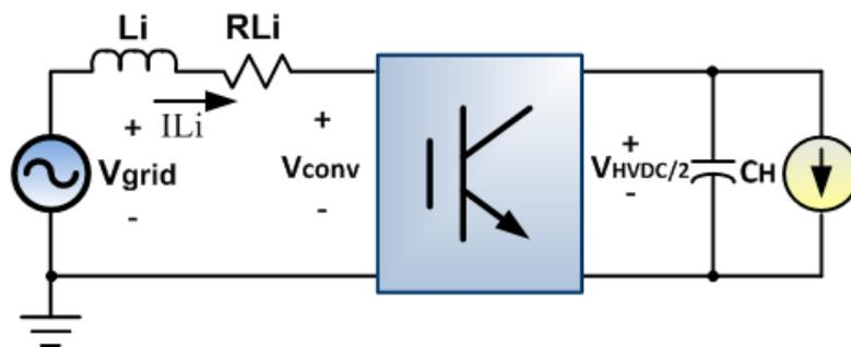
Fig. 4.3 Diagrama de la planta de la etapa AC-DC.
