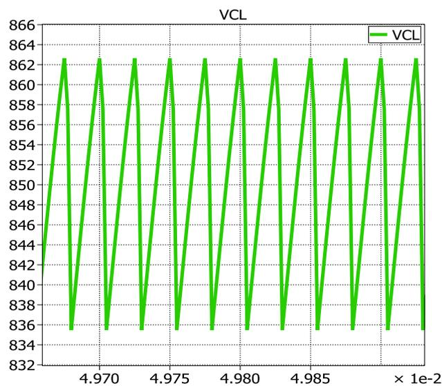
Fig. 3.8 Voltaje de rizado del capacitor  $C_L$ .
