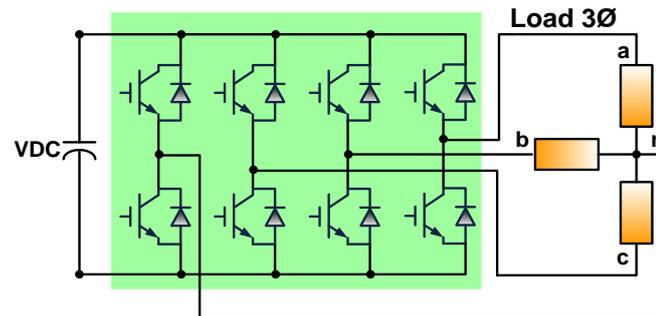
Fig. 2.17 Convertidor DC-AC trifásico.
