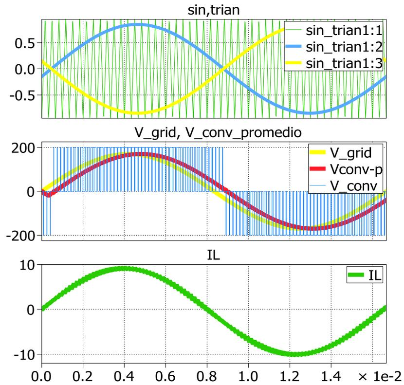
Fig. 2.20 Formas de onda del convertidor AC-DC.
