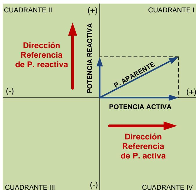
Fig. 2.5 Referencia de flujos de potencia [5].
