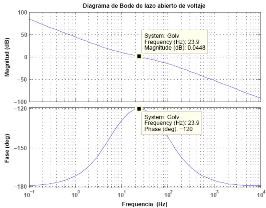
Fig. 4.7 Diagrama de bode de voltaje del convertidor AC-DC.
