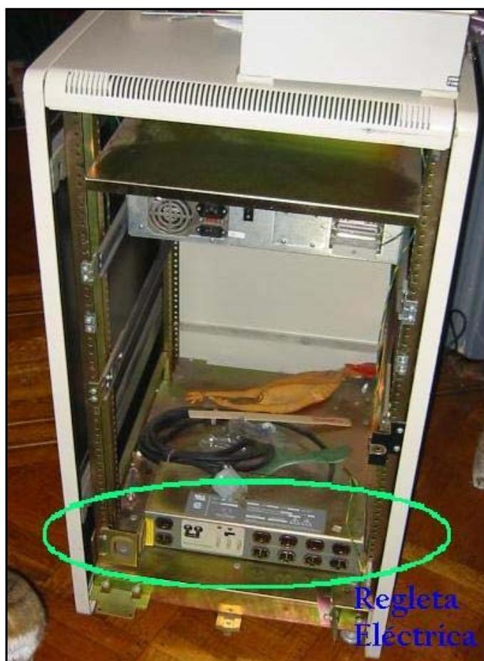
**Figura 2.14** Rack con regleta eléctrica montada
