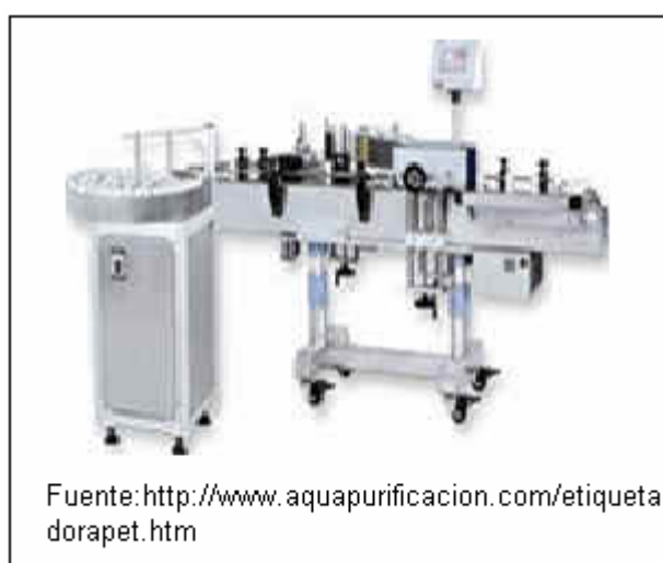
Figura 1.4 Máquina etiquetadora para botellas
