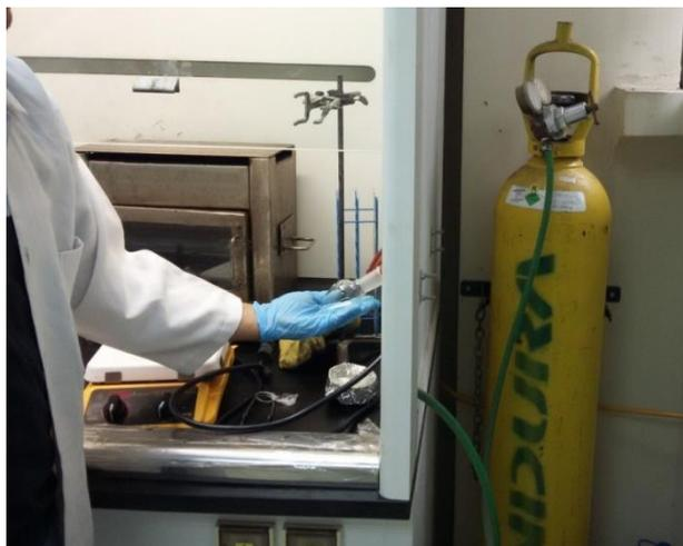
**Figura 2.11. Secado del matraz con corriente de nitrógeno**
