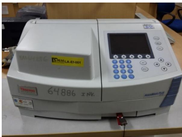
Figura 2.16. Espectrofotómetro UV visible usado para la determinación de amonio y nitratos
