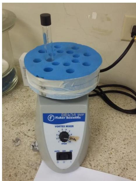
**Figura 2.10. Agitación mecánica de la muestra con el vortex mixer.**
