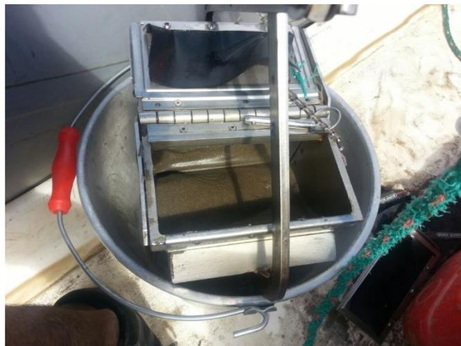
**Figura 2.4. Draga manual usada en la toma de muestras**
