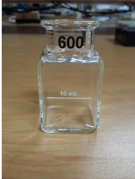
**Fig. A3. Celda de espectrofotómetro HACH**
