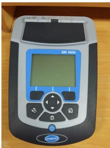
Figura 2.19. Espectrofotómetro Hach DR 1900
