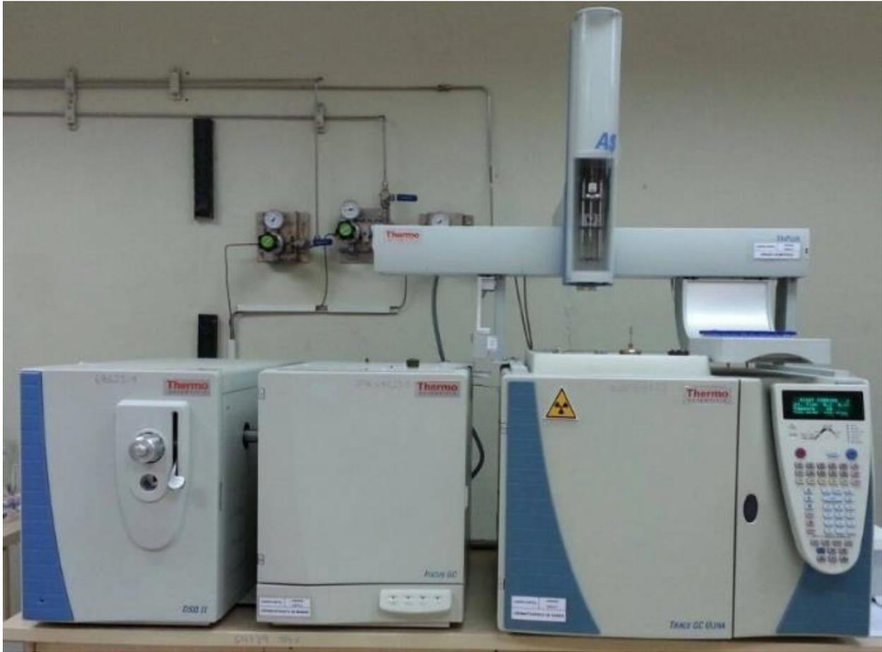
**Fig. A5. Cromatógrafo de gases marca Thermo Sientific**
