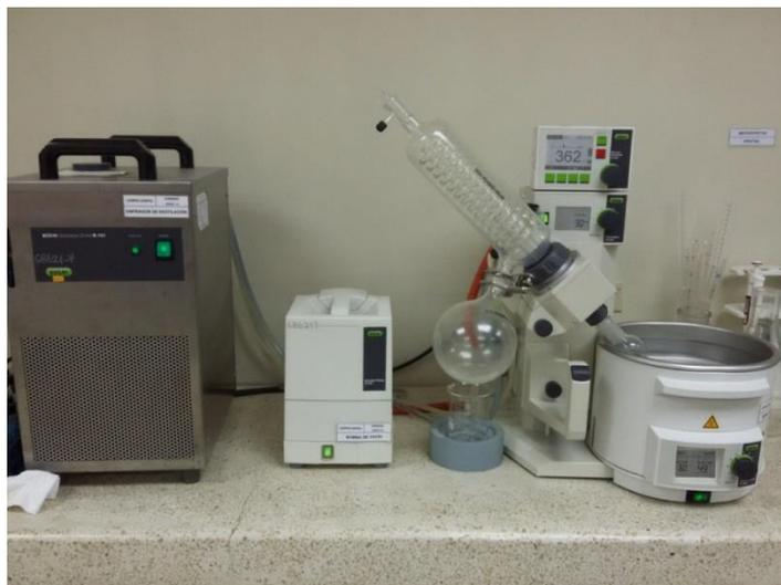
**Figura 2.8. Evaporador rotatorio utilizado para concentrar las muestras**
