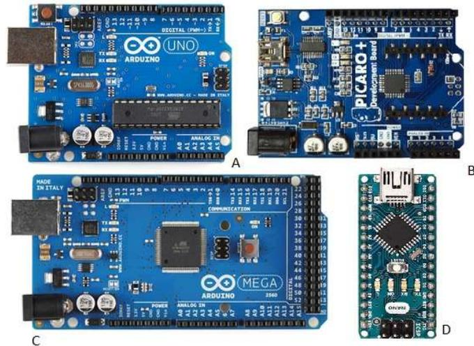
**Figura 2.3: Diferentes placas microcontroladores entre los cuales tenemos: A) Arduino UNO B). Pícaro+ C). Arduino MEGA y D). Arduino Micro [10]**
