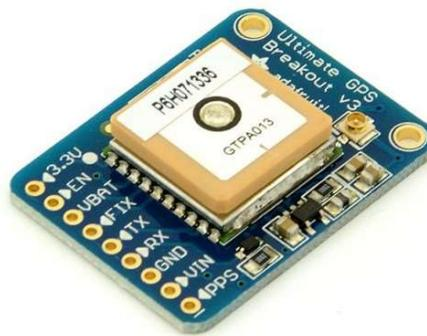
**Figura 2.7: Módulo Adafruit Ultimate GPS. [18]**
