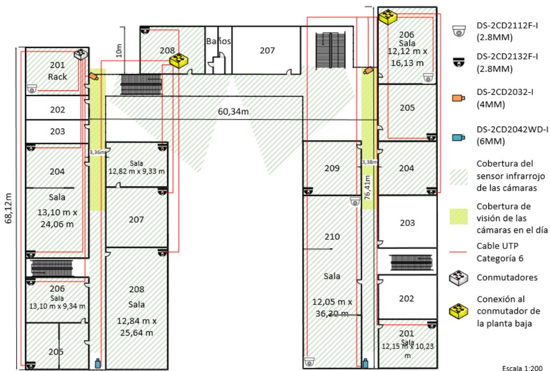
**Figura 3.10: Ubicación de las cámaras en los edificios 27 A y 27 B, planta alta.**
