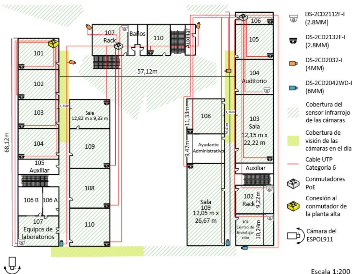
**Figura 3.9: Ubicación de las cámaras en los edificios 27 A y 27 B, planta baja.**
