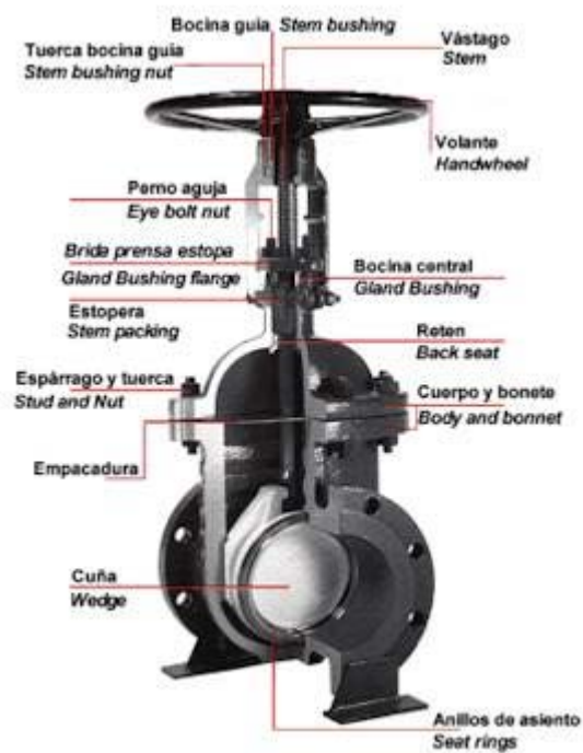
Figura 1-2 Características de la válvula de compuerta
