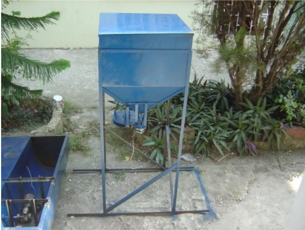
Foto E6: Tolva para deposito del alimento.
