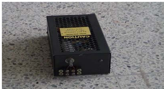
FIGURA 1.4.2.1. FUENTE DE VOLTAJE PARA EL SENSOR.
