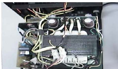
FIGURA 3.2.1.2. CIRCUITO DE ACTIVACIÓN DE LA ETAPA AMPLIFICADORA PARA LA BOMBA DC.
