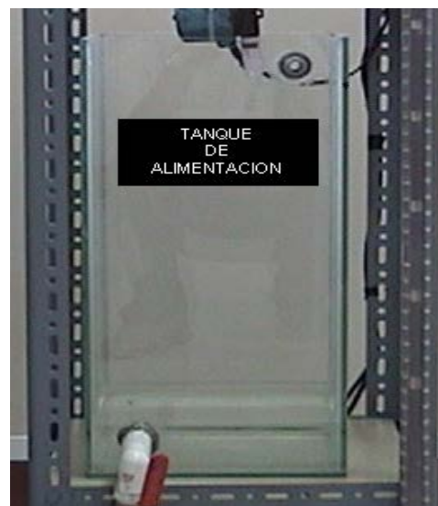
FIGURA 4.3.4.1.1 TANQUE DE ALIMENTACIÓN O SUMINISTRO.
