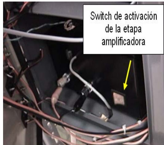
FIGURA 4.3.4.1.2 FUENTE DE ACTIVACIÓN DEL SISTEMA.
