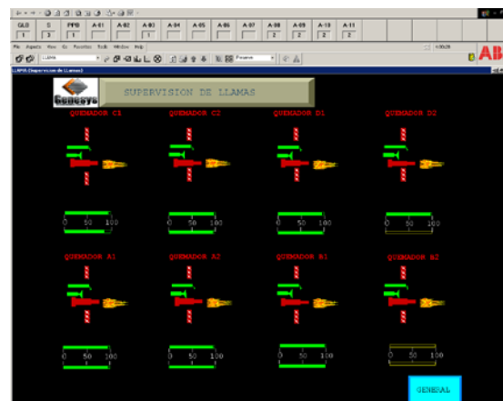
Figura 8.28 .- Supervisión de llamas
