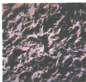
Fig. 4. Fotografía al microscopio electrónico de una superficie chorreada con abrasivo angular.
