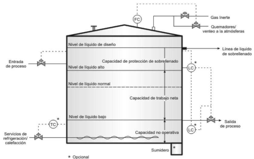
**FIGURA 3.21. ESQUEMA DEL TANQUE CILINDRICO CON SUS ACCESORIOS.**
