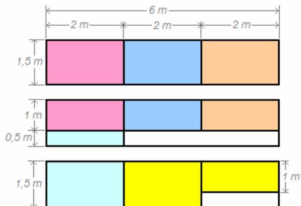
**FIGURA 3.19. TRAZADO DE LAS PLANCHAS DE ACERO PARA LA CONSTRUCCIÓN DEL TANQUE DE PASO.**
