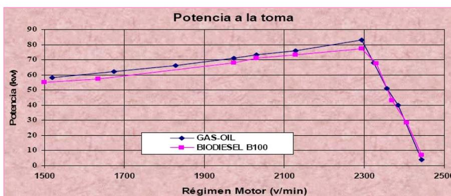
**FIGURA 2.8. COMPARACIÓN DEL RENDIMIENTO ENERGÉTICO BIODIESEL-GASÓLEO (DÍAZ & BUETI, 2004).**
