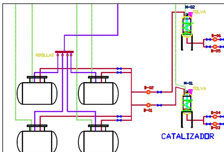
**FIGURA 2.14. DISEÑO DEL PROCESO DE MEZCLA**
