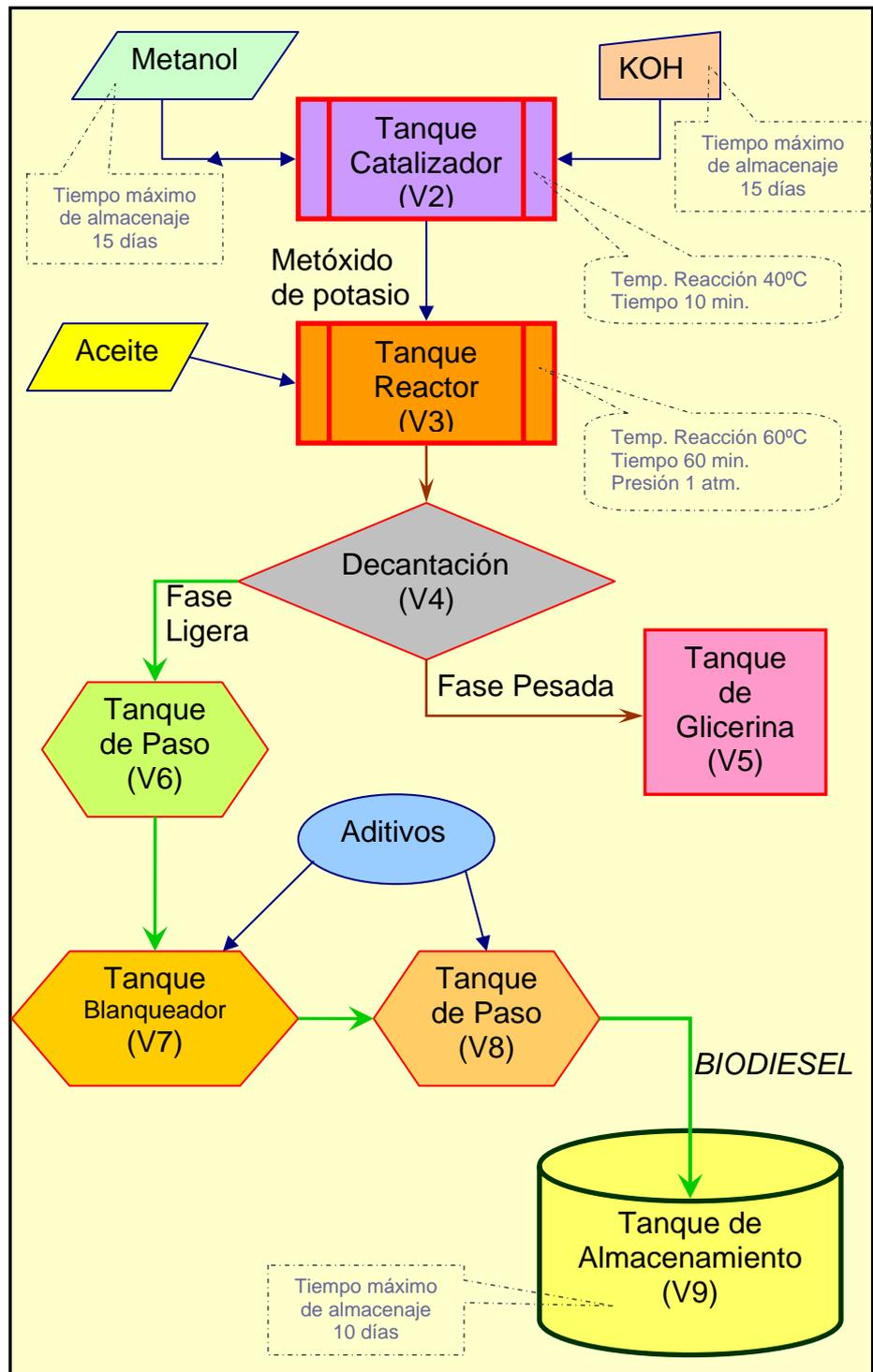
**FIGURA 2.13. DISEÑO DEL PROCESO DE PRODUCCIÓN DE BIODIESEL**
