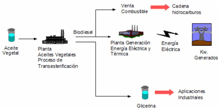
**FIGURA 2.1. ESQUEMA DE PRODUCCIÓN Y DESTINO DEL BIODIESEL.**
