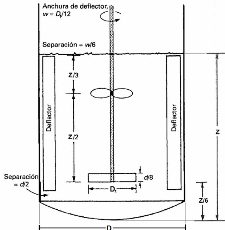
**FIGURA 3.7. DISEÑO BÁSICO DE UN TANQUE AGITADO**
