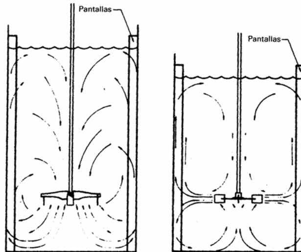
**FIGURA 3.9. CONFIGURACIONES TÍPICAS DE TANQUES DE AGITACIÓN Y PATRONES DE FLUJO PARA ÁLABES DE FLUJO AXIAL Y RADIAL.**
