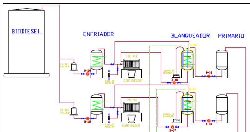
**FIGURA 2.17. DISEÑO DEL PROCESO DE PURIFICACIÓN Y ALMACENAMIENTO.**
