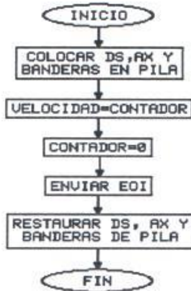
Figura 5.13 Diagrama de flujo del procedimiento "muestrear"
