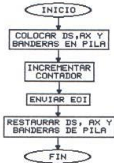
Figura 5.12 Diagrama de flujo del procedimiento "contar"
