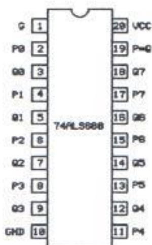
Figura 4.2 Diagrama de conexión del 74ALS688
