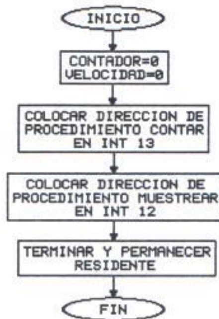
Figura 5.11 Diagrama de flujo del programa "contador.com"
