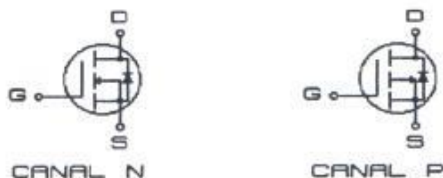
Figura 3.4 Símbolos esquemáticos del transistor de potencia MOSFET de enriquecimiento
