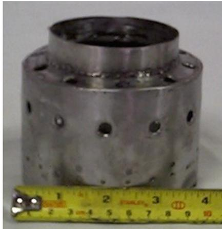
**Figura 3.7. Cuerpo exterior de la cámara de combustión**
