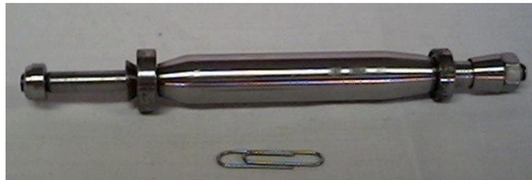
**Fig. 3.3. Eje de compresor-turbina con separadores y rodamientos.**
