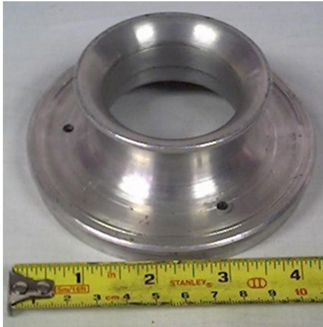
**Fig. 3.2. Toma frontal de aire del compresor**
