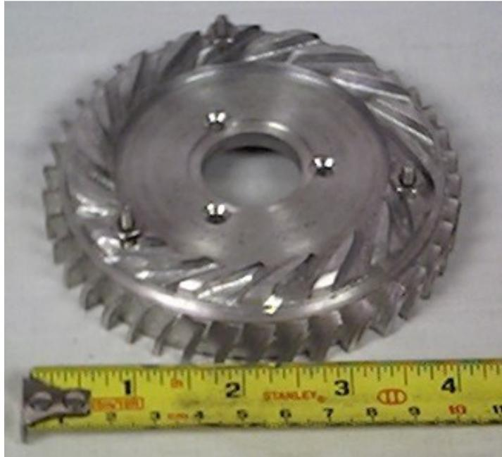
**Fig. 3.1. Estator de compresor**
