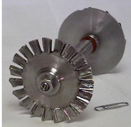
**Fig. 3.10. Rotor de turbina acoplado al eje.**
