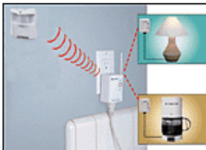
Figura 4.7. Funcionamiento del sensor Eagle-eye
