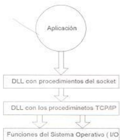
Figura # 2.3 Interacción de la aplicación con el sistema operativo.
