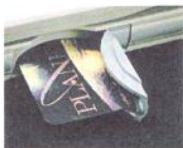
Figura 4.8 Tarjeta inteligente en la ranura de un teléfono portátil Planet 1.
