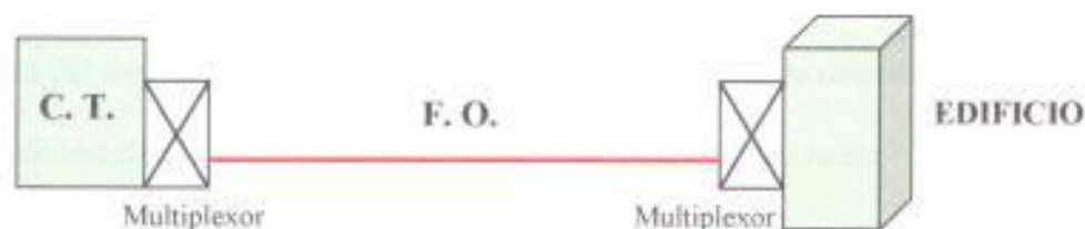
Fig. 5.2 Conexión de FO entre la central y el Edificio
