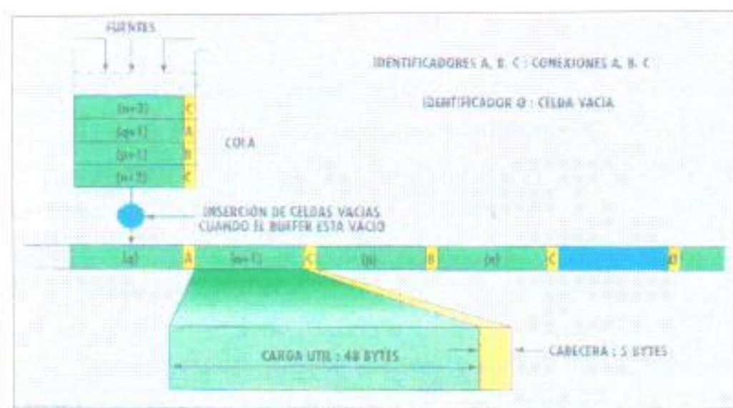
Figura 2.6: Multiplexación de celdas ATM.
