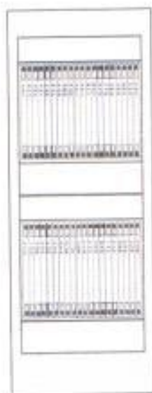
Figura 3.9. Dos sistemas de 10 Gbit/s pueden interconectarse directamente, formando un sistema de 20Gbit/s
