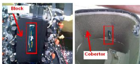
Figura 4.22: Ubicación de la etiqueta Gen 2 Surface Independent Epoxy Tag en un motor YAMAHA de 150 HP
