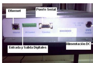
Figura 3.2: Puertos del INfinity 510 y alimentación
