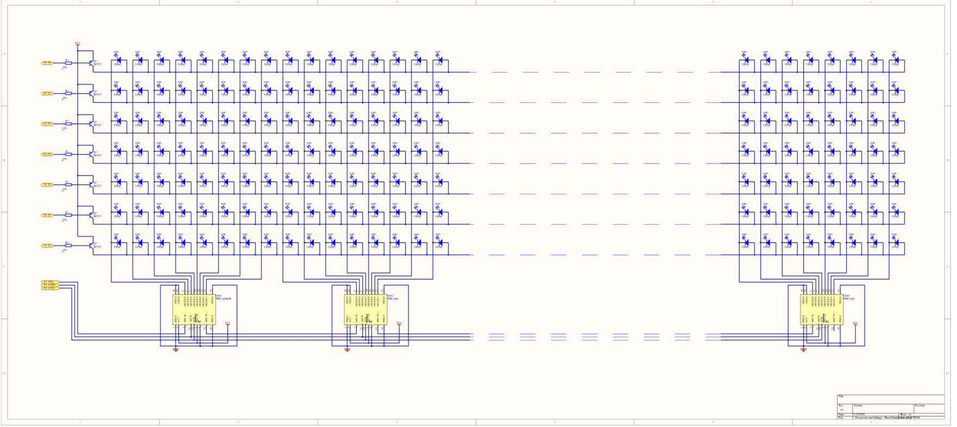
Figura 2.12: Diagrama Esquemático (Hardware Panel Electrónico LEDs)
