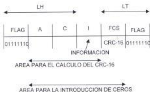
FIG. 2.10.- Area cubierta por el FCS
