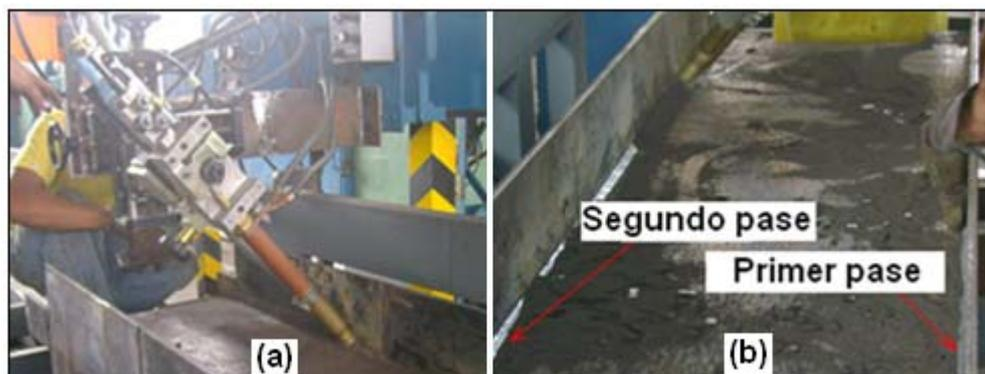
**FIGURA 4.38: SOLDADURA DEL SEGUNDO CORDÓN.**
