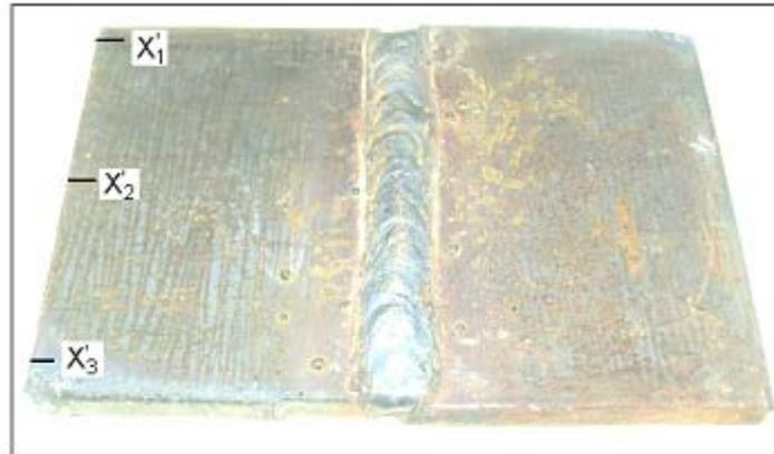
**FIGURA 4.5: PUNTOS DONDE SE TOMARON LAS MEDIDAS DESPUÉS DE LA SOLDADURA.**
