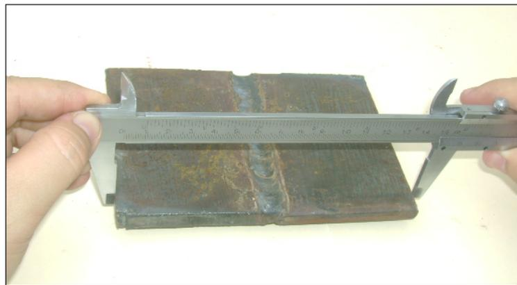
**FIGURA 4.8: TERCERA MEDICIÓN,  $X_3' = 149.70$  mm**
