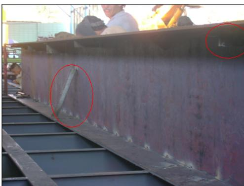
**FIGURA 4.30: EXTRACCIÓN DE LOS SOPORTES DE LAS ALAS**
