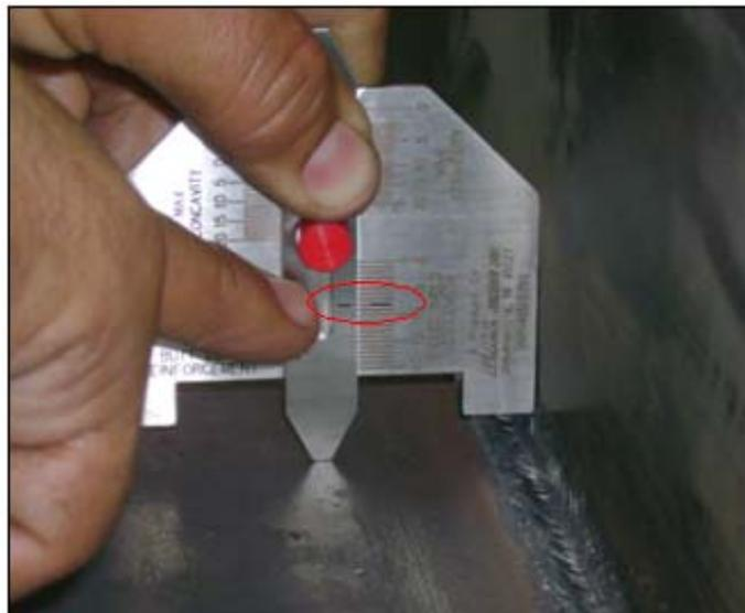
**FIGURA 4.47: MEDICIÓN DE LA ALTURA DE LA PIERNA**
