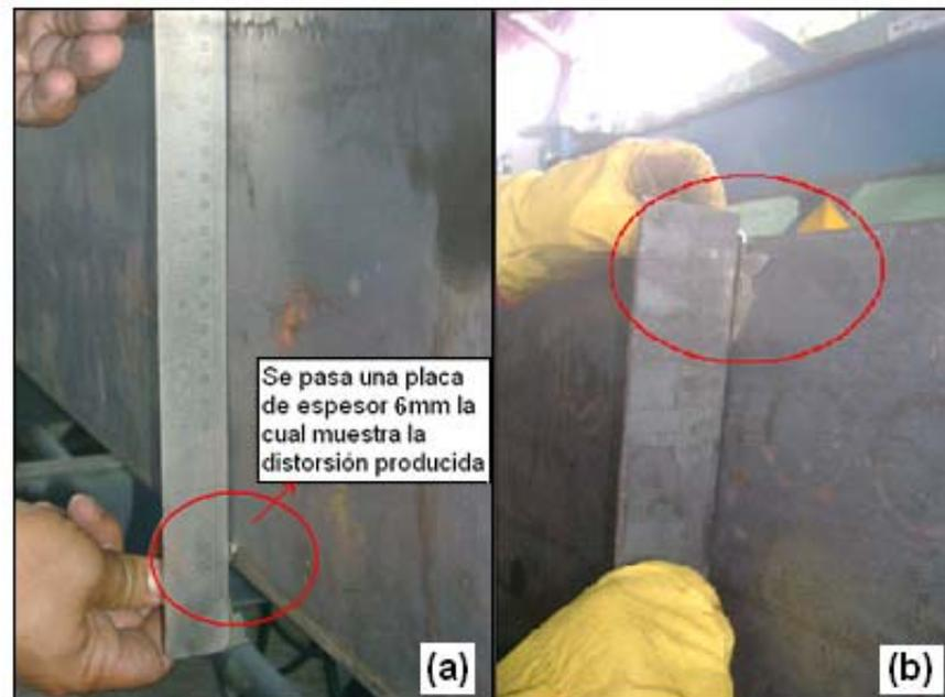
**FIGURA 4.35: DISTORSIÓN ANGULAR PROVOCADA POR EL CALENTAMIENTO**
