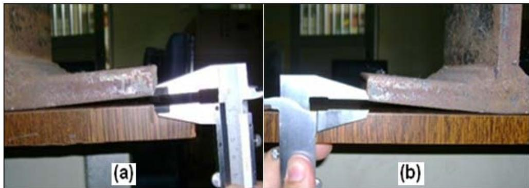
**FIGURA 4.55: MEDICIÓN REAL DE LA DISTORSIÓN – JUNTA A FILETE**
