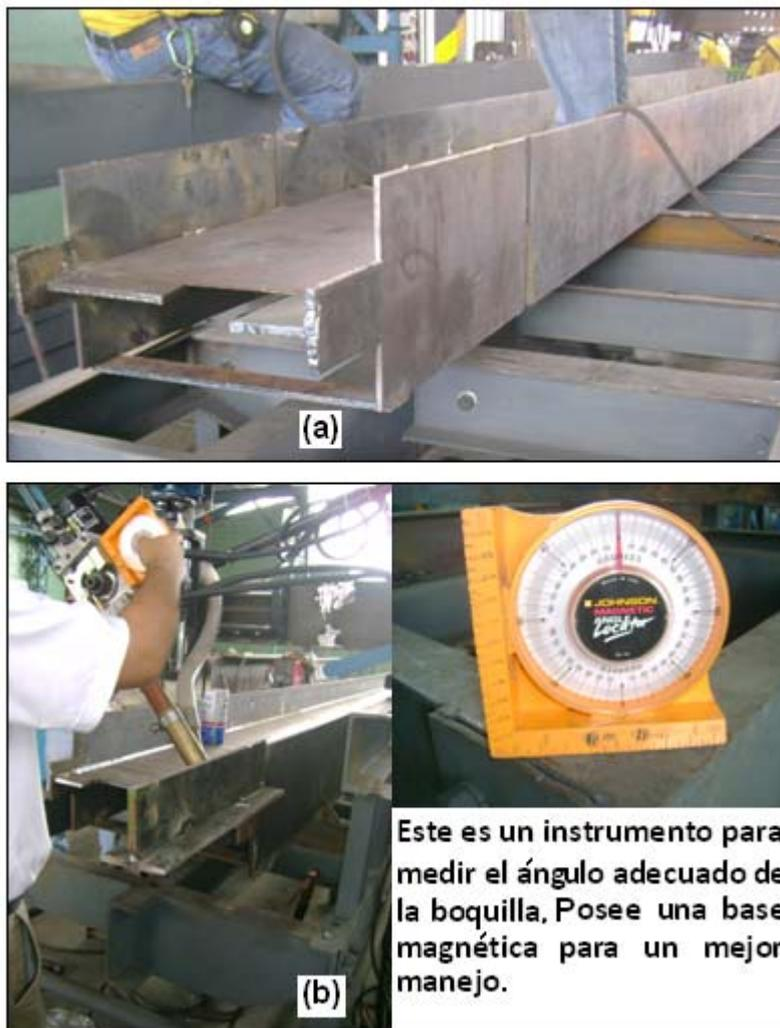
**FIGURA 4.31: ALINEACIÓN DE LA VIGA EN LA MAQUINA**
