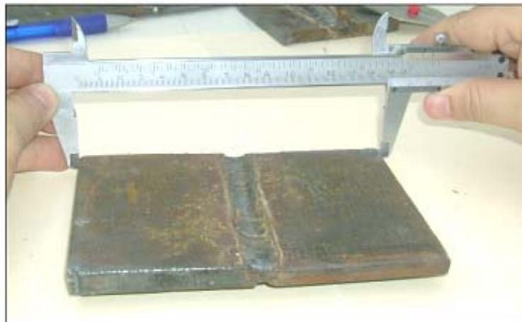
**FIGURA 4.6: PRIMERA MEDICIÓN,  $X_1' = 149.60$  mm**
