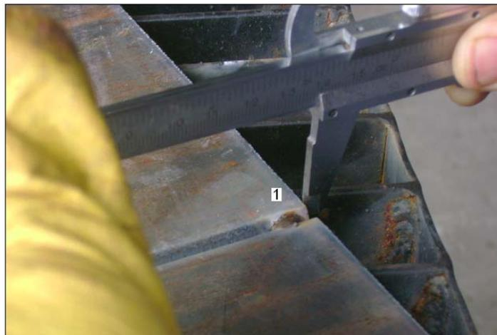
**FIGURA 4.21: PRIMERA MEDICIÓN,  $X_1 = 141,35$  mm**
