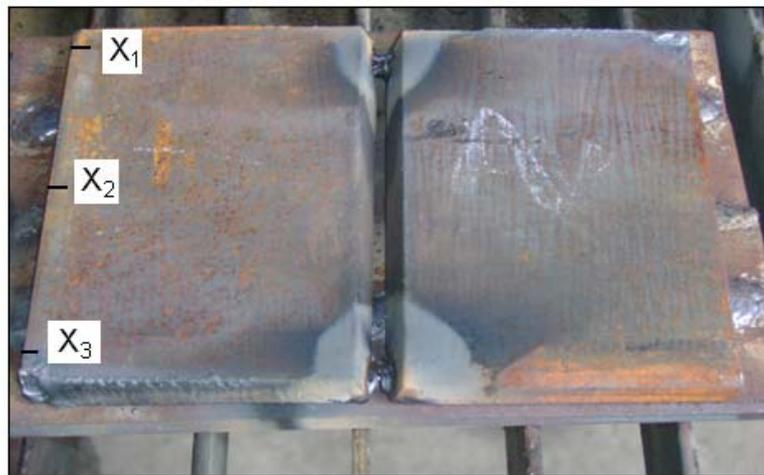
**FIGURA 4.3: PUNTOS DONDE SE TOMARON LAS MEDIDAS ANTES DE SOLDAR LAS PLANCHAS.**
