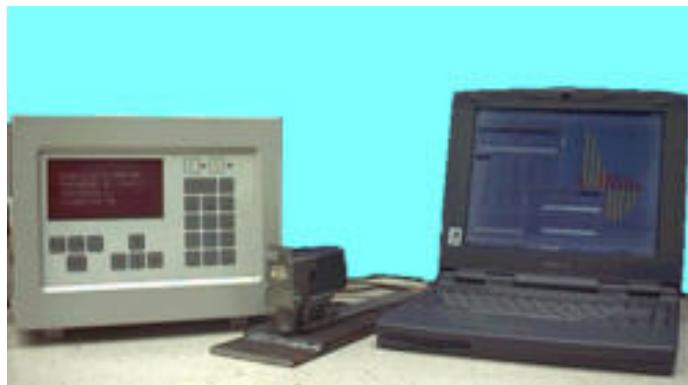
**FIGURA 2.19: EQUIPO DE ULTRASONIDO PARA MEDICIÓN DE ESFUERZOS RESIDUALES (SISTEMA UCC) (9).**
