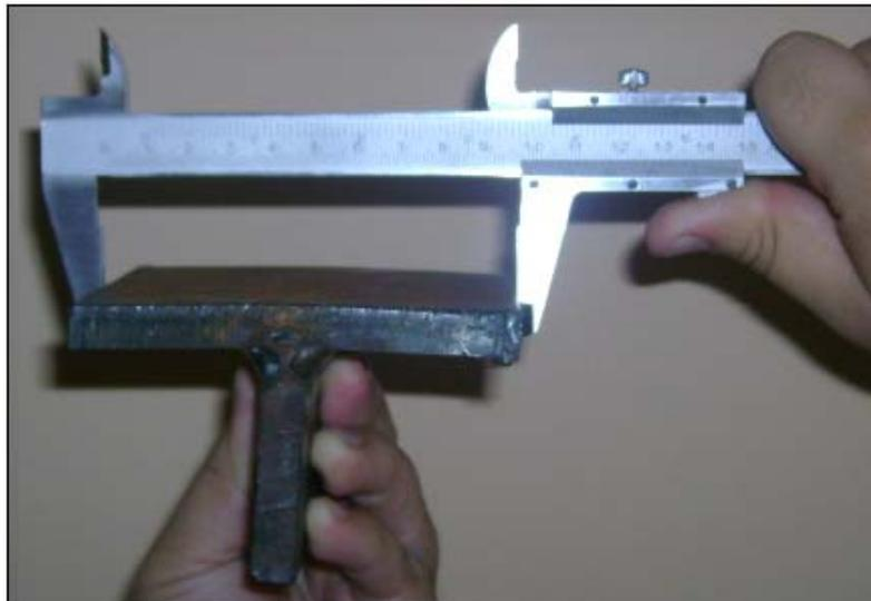
**FIGURA 4.15: SEGUNDA MEDICIÓN,  $X_2' = 99.30$  mm**
