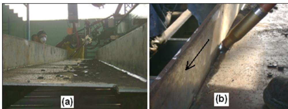
**FIGURA 4.42: SOLDADURA DEL CUARTO CORDÓN CON SAW.**
