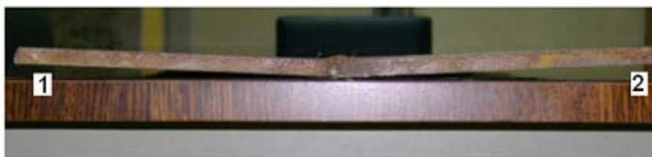
**FIGURA 4.51: EFECTO DE LA DISTORSIÓN ANGULAR**
