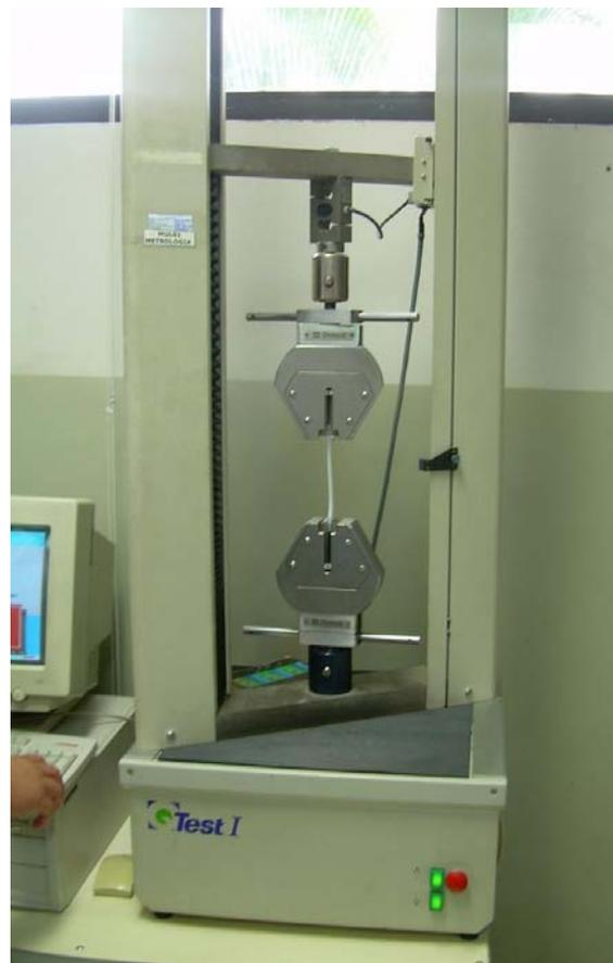
FIGURA 3.9. TENSÓMETRO QTEST I
