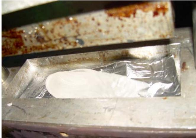
FIGURA 3.5. INSERCIÓN DEL MATERIAL EXTRUIDO EN LA PRENSA
