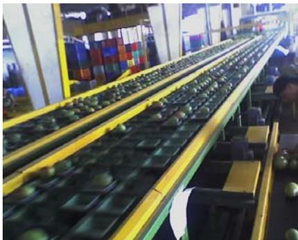
**FIGURA 2.4 MÁQUINA CLASIFICADORA**
