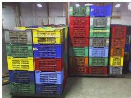
**FIGURA 4.7 PRUEBA DE FORMACIÓN DE PALLETS DE 7 PISOS DE ALTO.**
