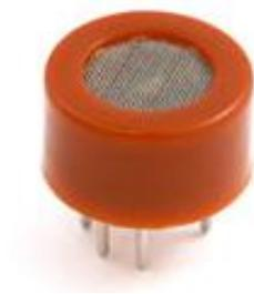
Figura 2.4.2 – Sensor de Gas MQ3 [6]
