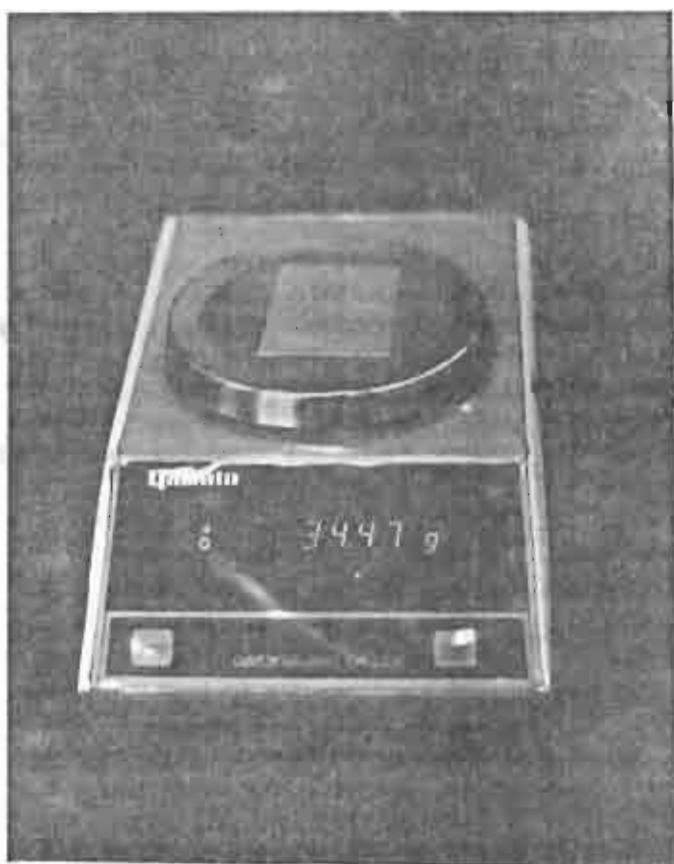
Figura No. 25 CONTROL DEL PESO ELECTRODEPOSITADO
