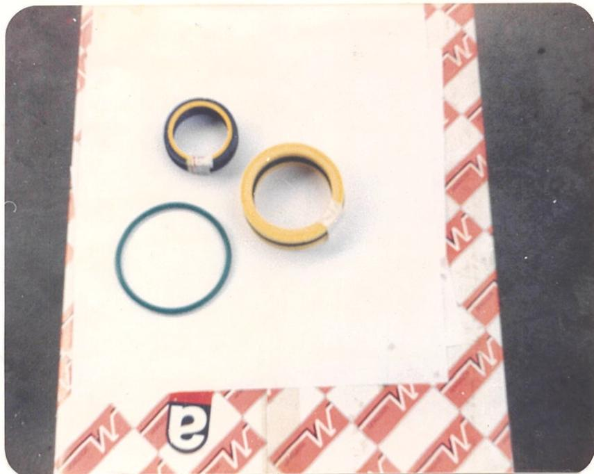
Fig. # 15.- SELLOS HIDRAULICOS REEMPLAZADOS.
