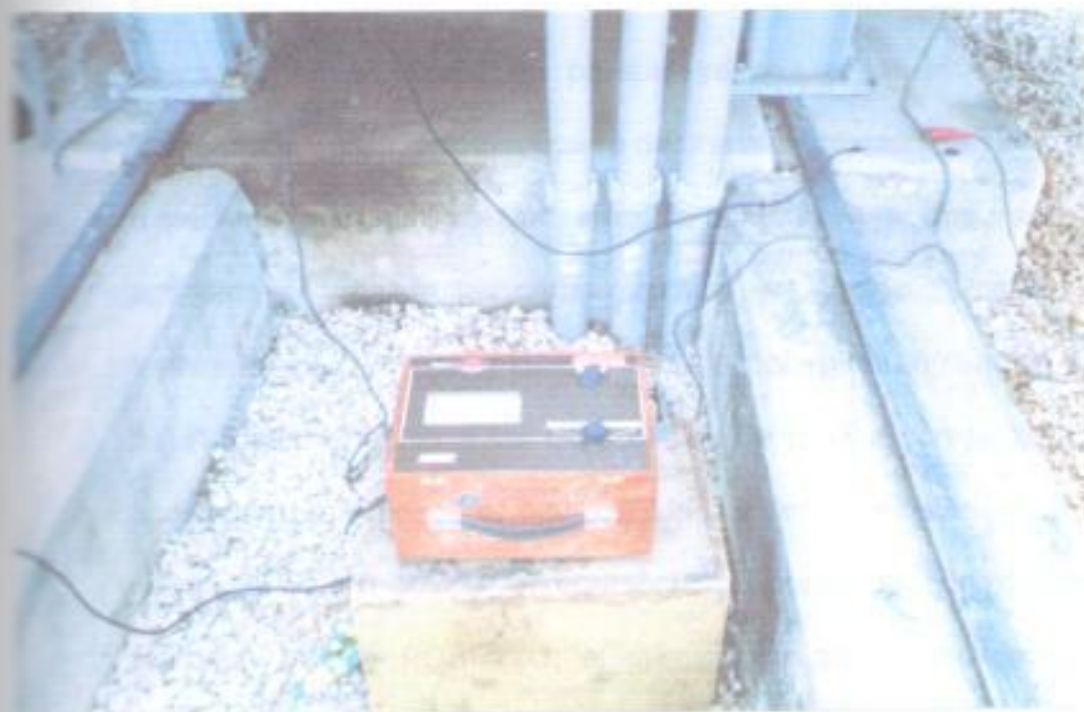
FIG. 3.5 Megger BIDDLE 5000 VDC (motorizado 120 VAC)
