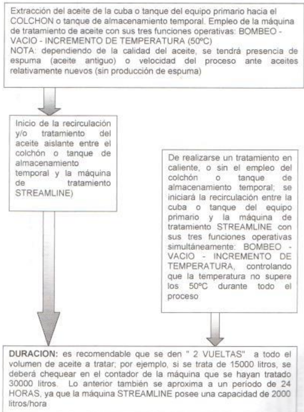
Esquema simplificado del proceso de tratamiento y/o recirculación del aceite aislante de equipos primarios
