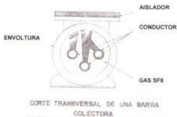
FIG. 4.13A Construcción interna de una barra colectora
