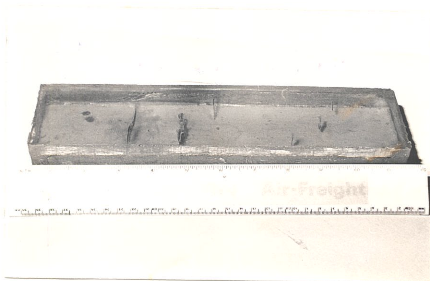
Fig.N°36 BLOQUE DE PLEXIGLAS CON FALLAS ARTIFICIALES
