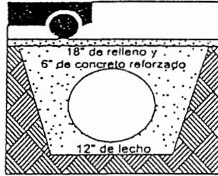
Los tanques necesitan una profundidad mínima de cubierta de 36 pulg. de relleno O 18 pulg. de relleno más 6 pulg. de concreto reforzado (consulte la Figura 9).
