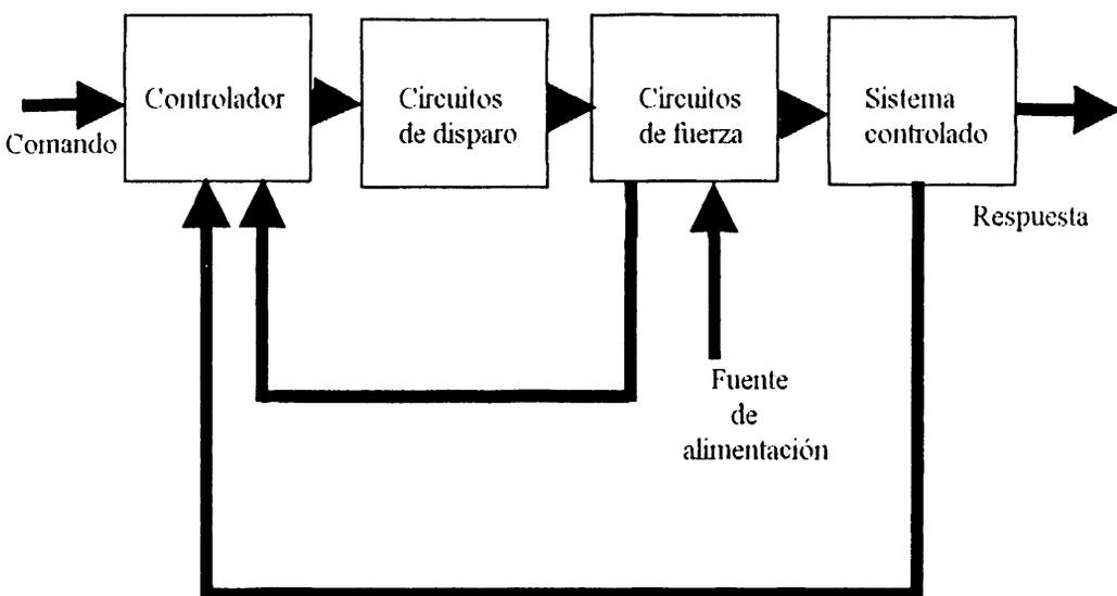
FIGURA 3.1 Diagrama de bloques de un convertidor típico.
