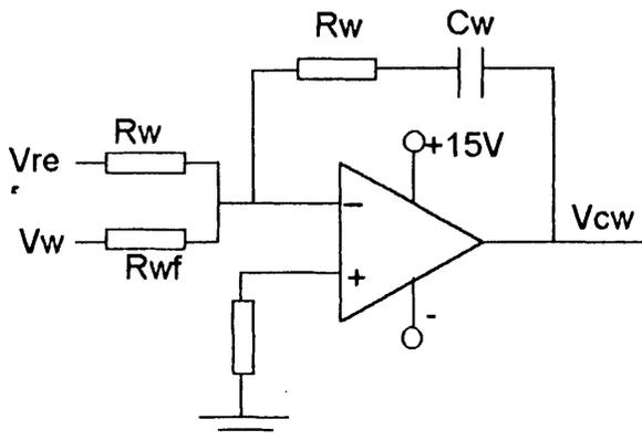
Fig. 4.13 Circuito controlador de velocidad
