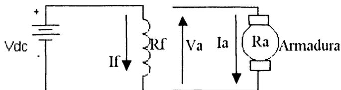
Figura 2.3 Diagrama esquemático de un motor de corriente continua con excitación separada.
