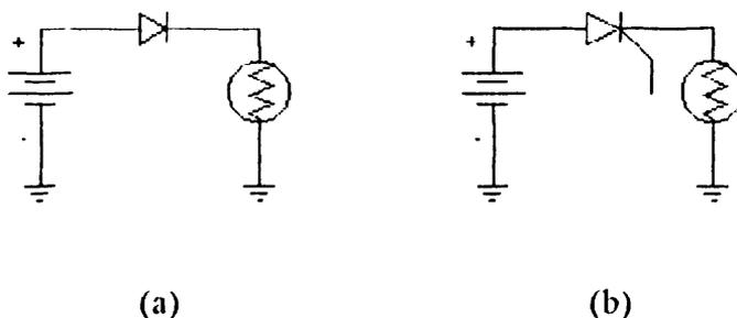
FIGURA 1.1 Análisis de conducción del diodo y tiristor
