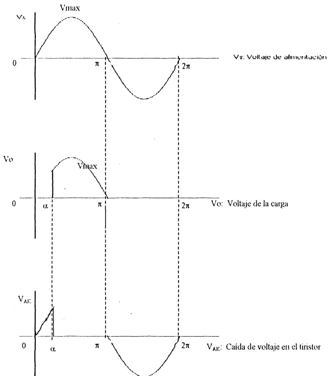
FIGURA 3.3 Formas de ondas de voltaje para el rectificador monofásico de media onda ( $0 < \alpha < \pi / 2$ )
