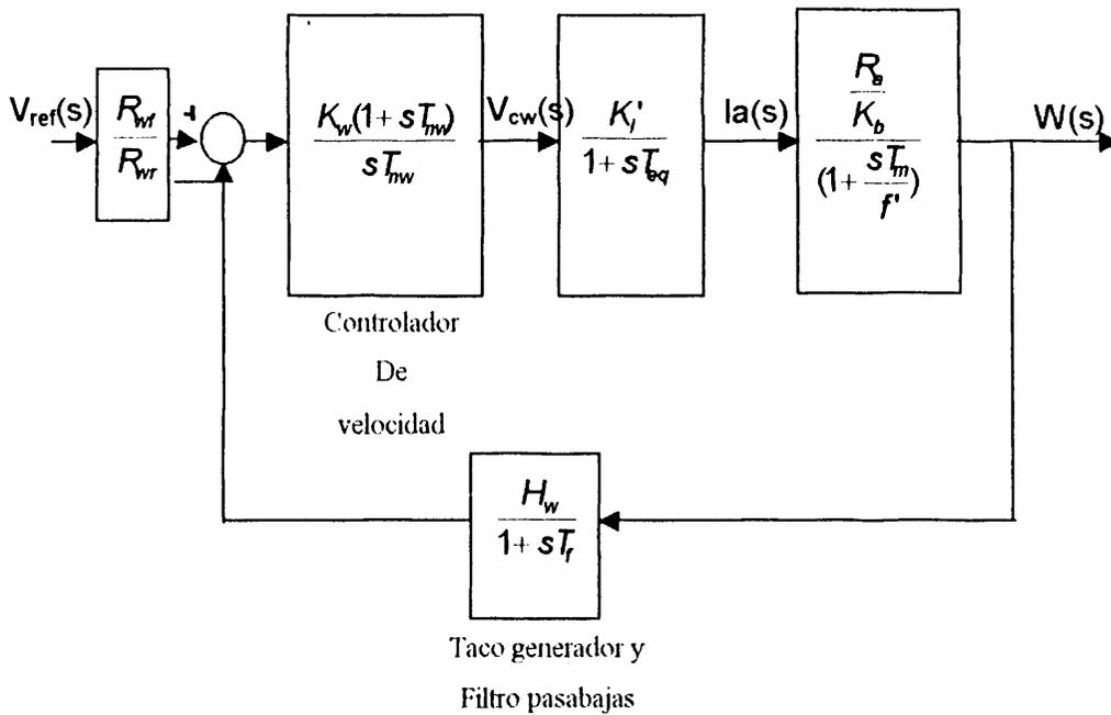
Fig. 4.12 Diagrama de bloques aproximado del controlador de velocidad.
