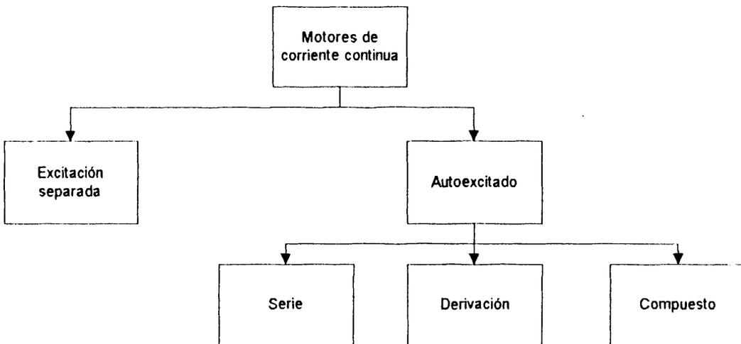
Figura 2.1 Subclases de los motores de corriente continua
