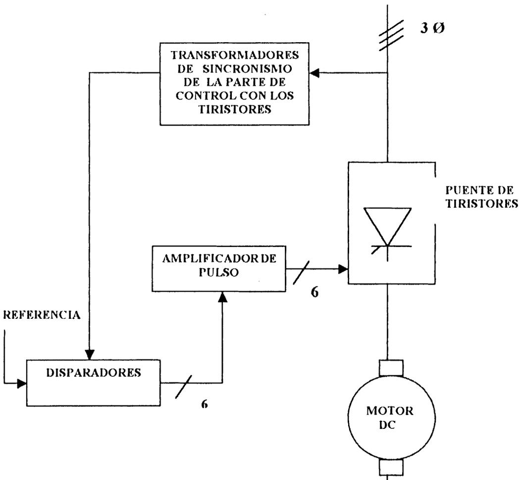
FIGURA 2.5. DIAGRAMA DEL SISTEMA EN LAZO ABIERTO
