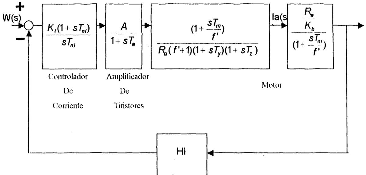
Fig. 4.8 Diagrama de bloques del circuito controlador
