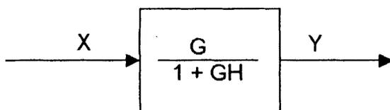
Aplicando dicha simplificación, se obtiene como función de transferencia equivalente la siguiente expresión :
