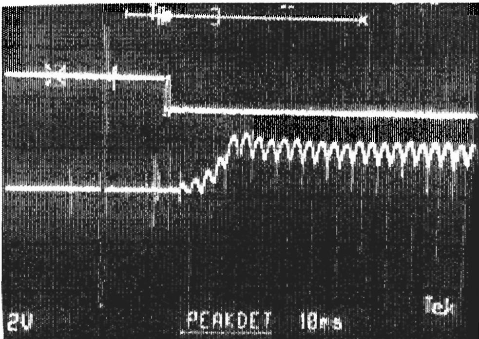
Figura 7.7 Respuesta fotográfica del controlador de corriente
