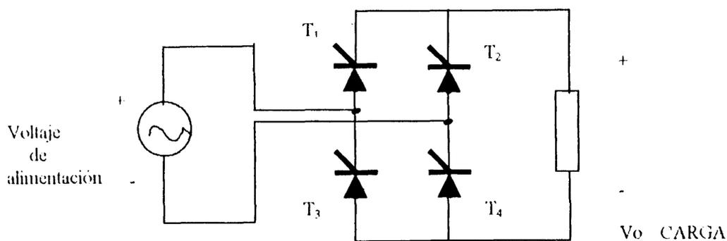
FIGURA 3.4 Circuito rectificador monofásico de onda completa
