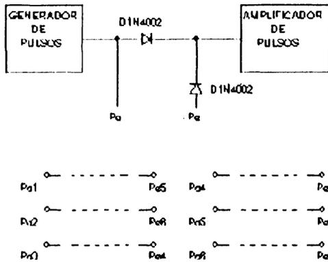
Fig. 5.8 Localización de terminales y diagrama de conexiones.
