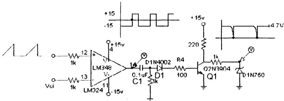
Fig. 5.4 Circuito comparador y disparador
