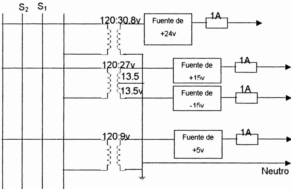
Figura 6.3 alimentación de las fuentes de voltajes reguladas
