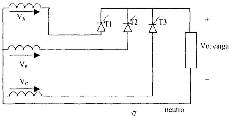
FIGURA 3.6 Rectificador Trifásico de media onda
