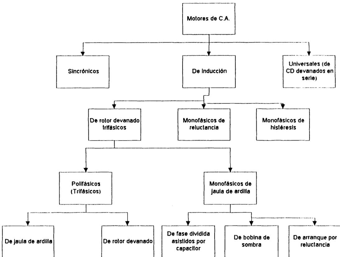
Figura 2.2 Subclases de los motores de corriente alterna.
