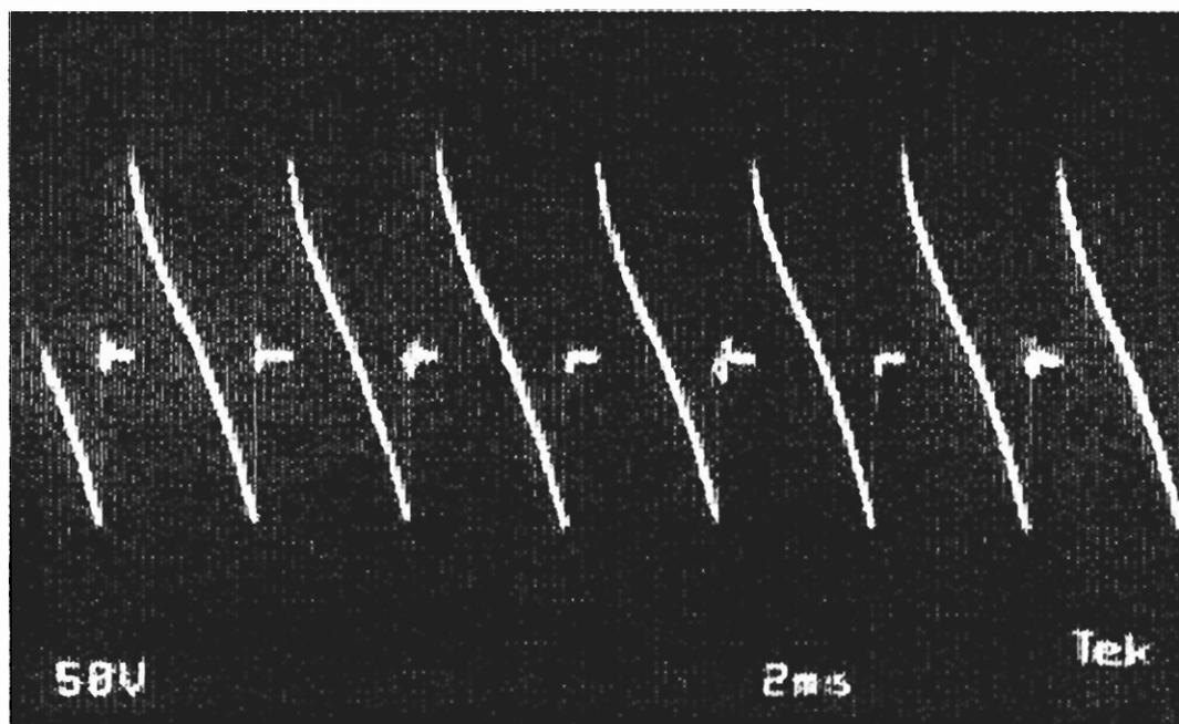
Figura 7.19 Forma de onda del voltaje de armadura para un ángulo de disparo  $\beta$
