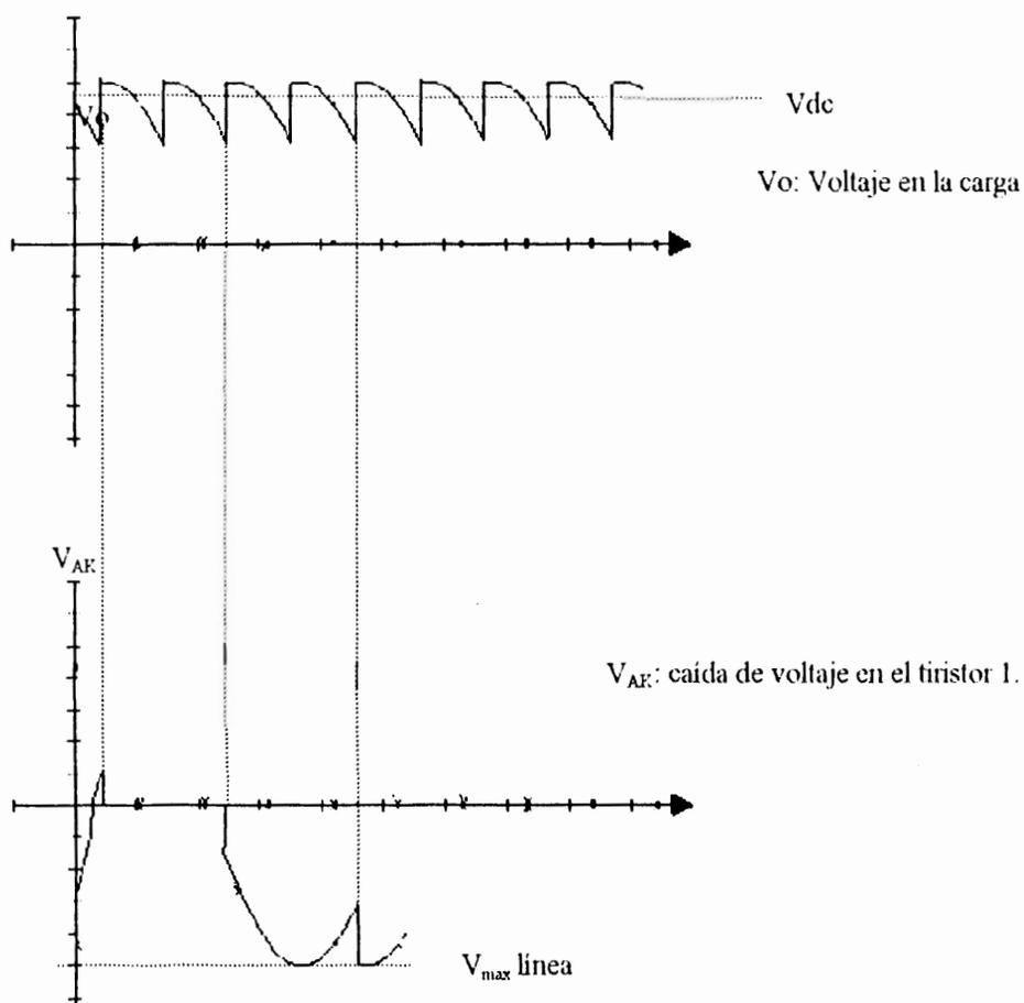
**FIGURA 3.9** Formas de onda de la salida y del tiristor 1 para el rectificador trifásico de onda completa.  $(0 < \alpha < \pi / 2)$
