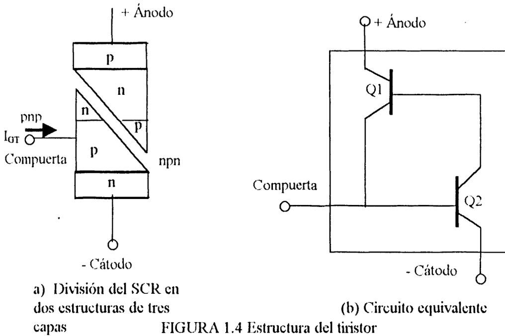
Como podemos apreciar en el circuito equivalente, uno de los transistores es npn, en tanto que el otro es PNP. Para nuestro análisis, la señal que se muestra en la Fig. 1.5a se aplicará en la compuerta del circuito de la Fig 1.5b.
