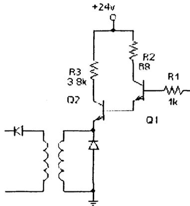
Figura 5.9 Etapa amplificadora y aisladora de pulsos
