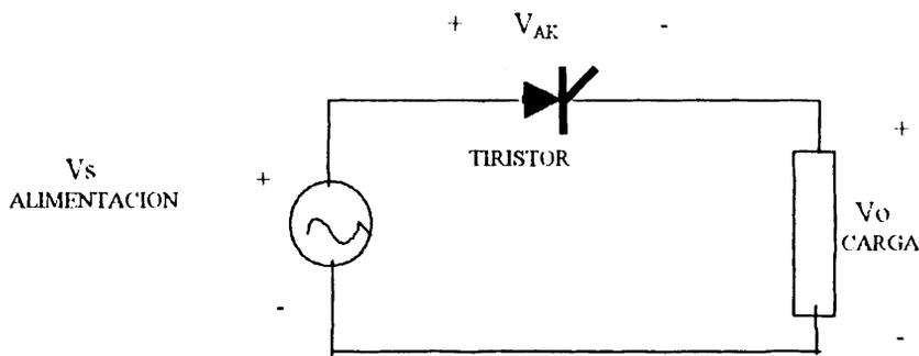
FIGURA 3.2 Circuito rectificador monofásico de media onda.
