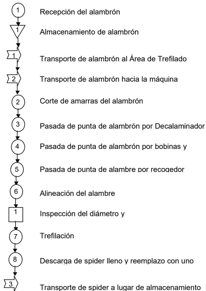
**FIGURA 3.7** Diagrama de operaciones del proceso de trefilado
