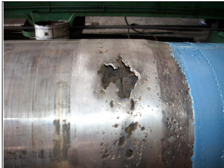
Figura 1.3.3: Pittings profundos en el eje
