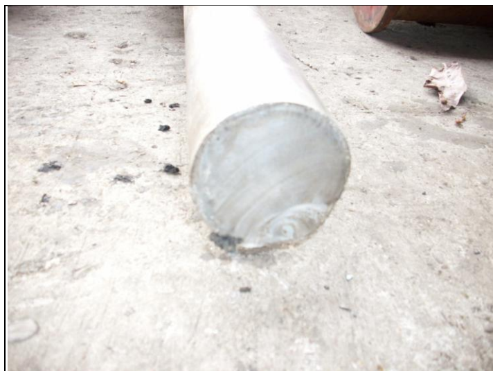
Figura 1.3.15: Eje cortado de tajo
