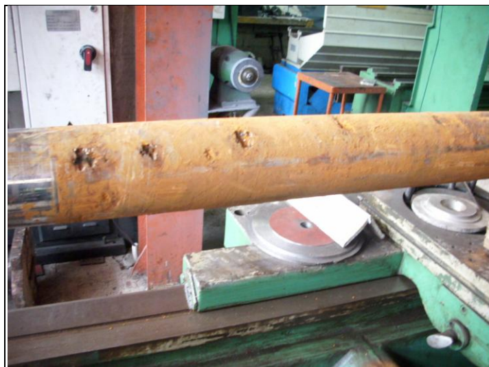
Figura 1.3.1: Daño en el sector de la camisa
