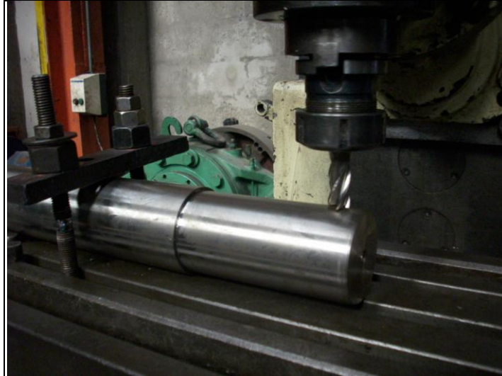
Figura 3.1.4: Eje en fresa para confección de chavetero
