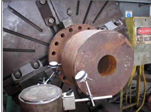
Figura 3.3.1: Brida lista para rectificar
