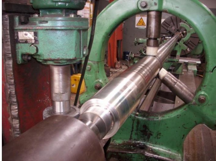
Figura 3.1.2: Eje alineado en el torno
