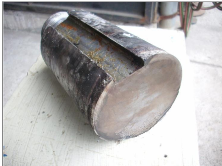
Figura 1.3.13: Rotura en el cono de la hélice
