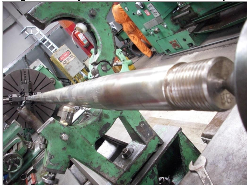
Figura 3.1.3: Eje alineado suspendido en tres puntos
