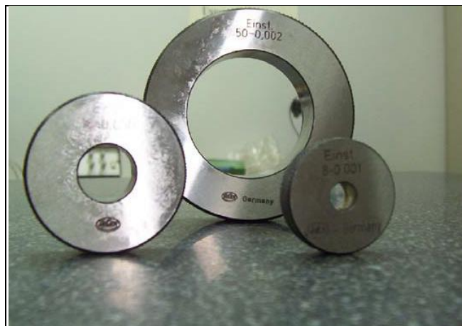
Figura 2.1.4: Patrones de diámetro exterior
