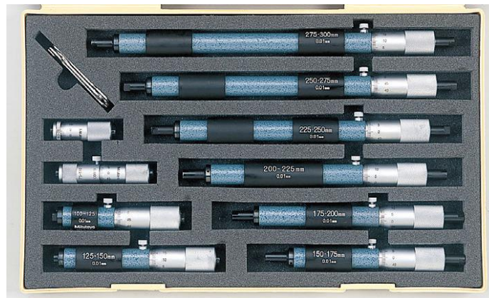
Figura 2.1.3: Patrones de diámetro interior
