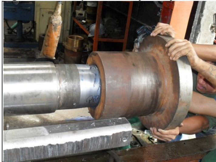
Figura 3.3.4: Acople de brida y trabajos finales
