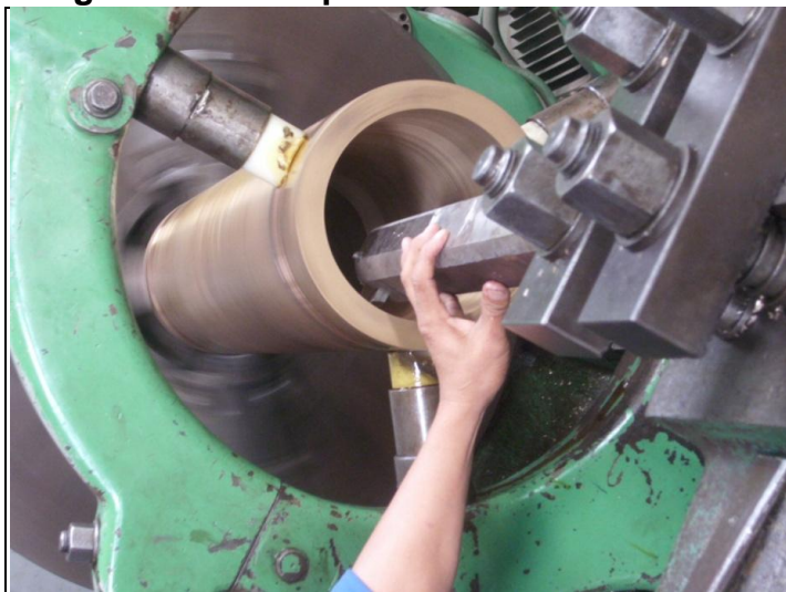
Figura 3.2.9: Maquinado interior de camisa
