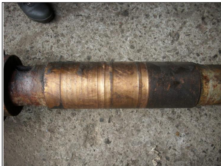
Figura 1.3.9: Desgaste por fricción de contaminantes
