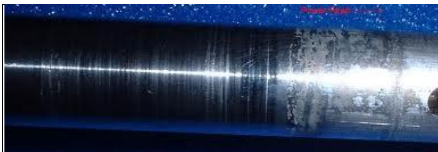
Figura 1.3.6: Rayones en el sector de los descansos
