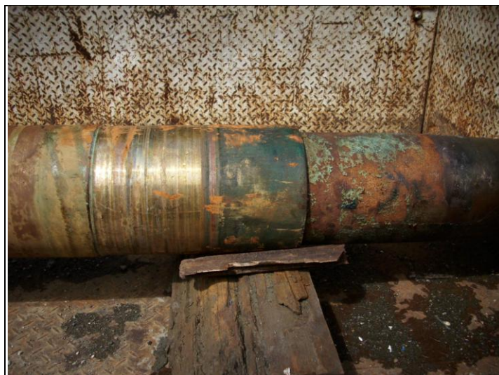
Figura 1.3.7: Desgaste por fricción
