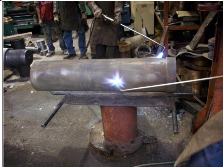
Figura 3.2.7: Puesta en caliente de camisa de bronce
