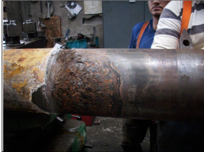
Figura 1.3.11: Daño del eje por rotura de camisa por esfuerzos
