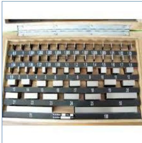
Figura 2.1.1: Caja de herramientas de bloques patrón de 0,005 mm
