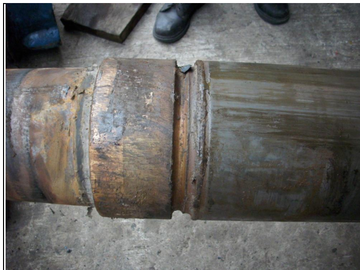
Figura 1.3.8: Desgaste por entrallamiento
