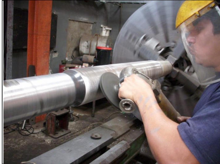
Figura 3.2.4: Pulida de imperfecciones
