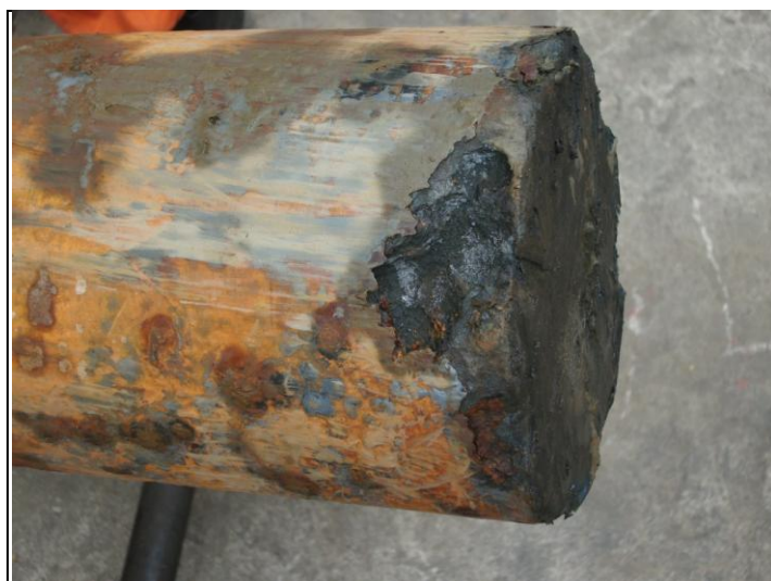
Figura 1.3.17: Problema mixto de sobreesfuerzo y pitting
