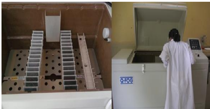
Figura 3.78: Análisis de resistencia a la corrosión en cámara salina
