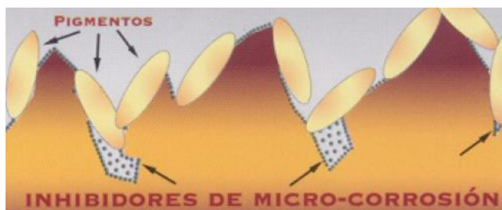
Figura 2.13: Recubrimiento con inhibidores de corrosión basado en carboxilato de amina
