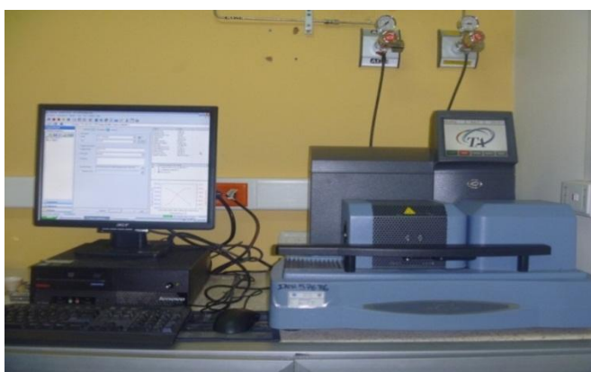
Figura 3.38: Analizador Térmico Fuente: Burgos O., Chávez M., Vera G.
