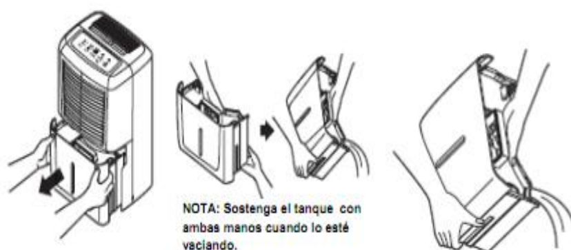
Figura 3.23: Vaciado del tanque del deshumidificador
