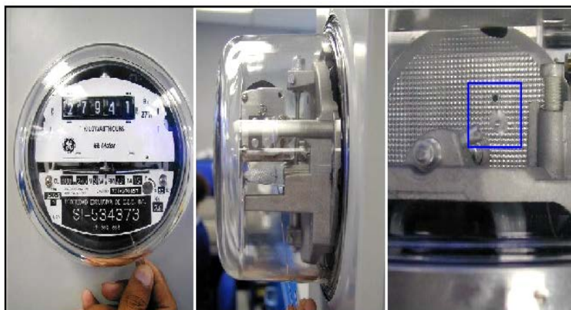
FIGURA 3.4: MEDIDOR CON VIDRIO PERFORADO.
