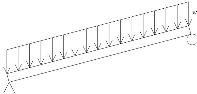
FIGURA 2.8. MODELADO DE LA CARGA SOBRE EL EJE
