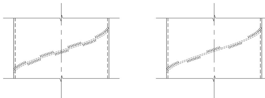
FIGURA 3.7. EJEMPLOS DE SOLDADURA INTERMITENTE Y ALTERNADA
