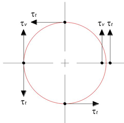
FIGURA 2.11. ESQUEMA DE ESFUERZOS EN EJE SÓLIDO
