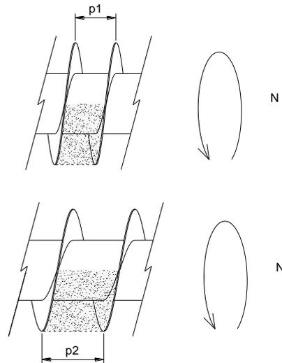
FIGURA 2.4. EFECTO DEL PASO HELICOIDAL EN EL LAVADO
