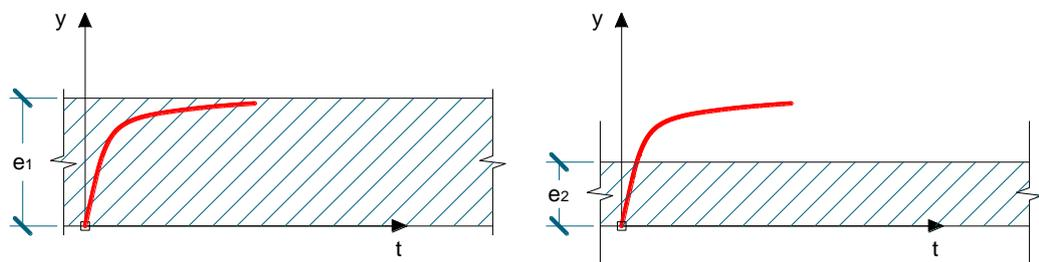
FIGURA 2.5. INFLUENCIA DE PICADURA CON RESPECTO AL ESPESOR
