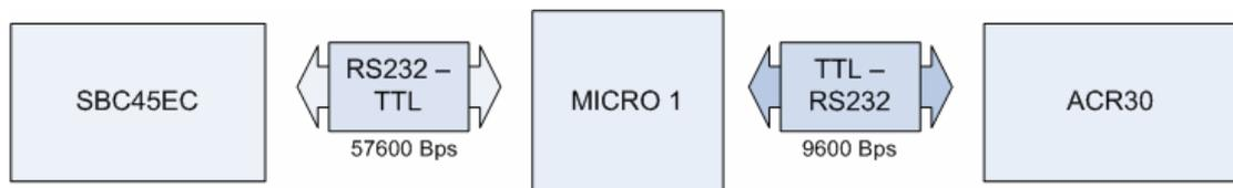
Figura 2.2 Diagrama de bloques del circuito de interfase entre el lector ACR30 y la tarjeta SBC45EC.
